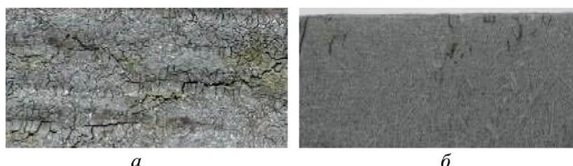
Рис. 4. Трещины в непрерывнолитой заготовке из стали S355J2 сечением 300×400 мм: *а* – наружная поверхность; *б* – корковая зона макротемплета (поперечное сечение)
