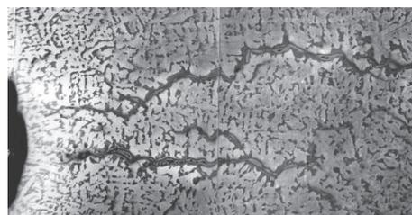
Рис. 2. Ликвационные междендритные зоны по месту дефекта в непрерывнолитой заготовке из стали 18ХГТ.  $\times 50$
