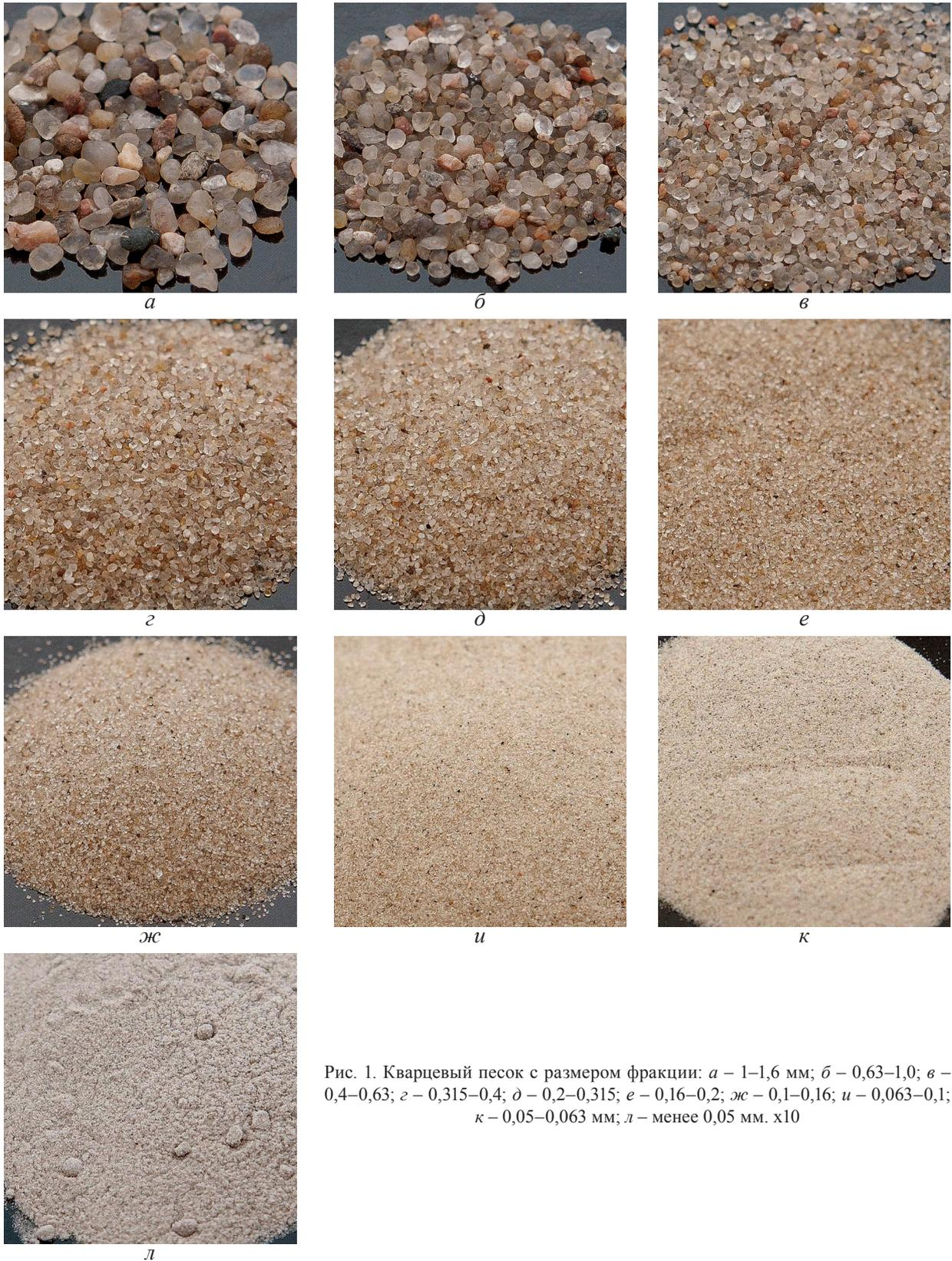
Рис. 1. Кварцевый песок с размером фракции: *а* – 1–1,6 мм; *б* – 0,63–1,0; *в* – 0,4–0,63; *г* – 0,315–0,4; *д* – 0,2–0,315; *е* – 0,16–0,2; *ж* – 0,1–0,16; *и* – 0,063–0,1; *к* – 0,05–0,063 мм; *л* – менее 0,05 мм.  $\times 10$
