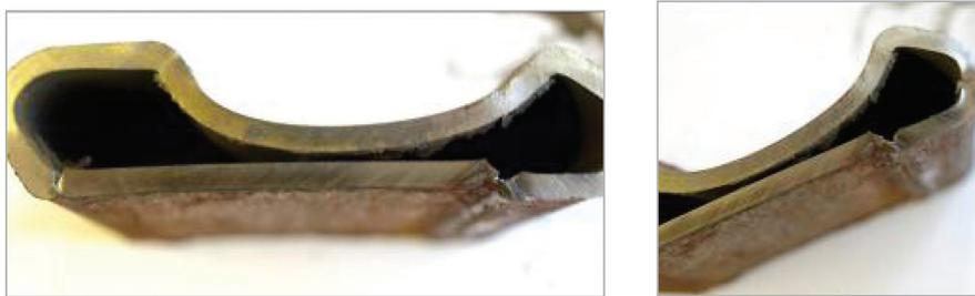
Рис. 12. Внешний вид образцов из трубы в состоянии поставки после испытаний на сплющивание
