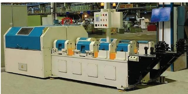
Рис. 8. Свивочная машина LC-2 (фирма «ТТМ»)
