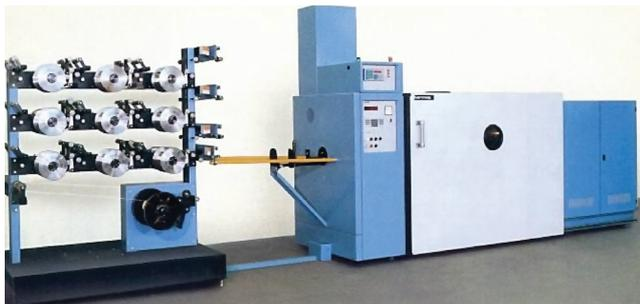
Рис. 6. Свивочная машина DV3TI (фирма «Barmag»)
