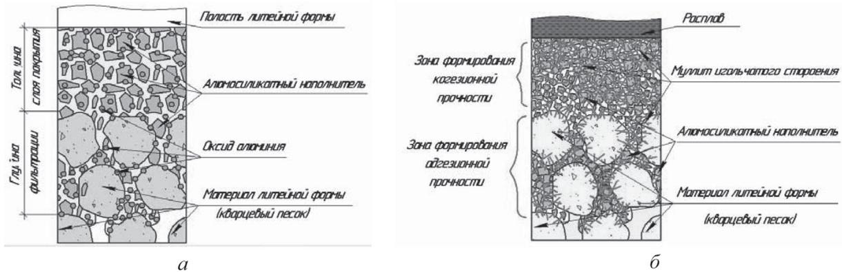
Рис. 6. Схема механизма повышения высокотемпературной прочности противопригарных покрытий: а – до взаимодействия с расплавом; б – в период взаимодействия
