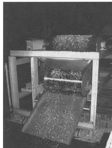
Рис. 1. Сушильная камера с барабаном и магнитный сепаратор
