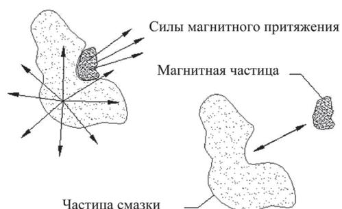
Рис. 2. Схема действия сил на частицу отработанной смазки при RSC-процессе
