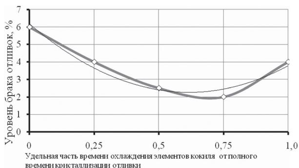
Рис. 2. Влияние времени охлаждения элементов кокиля на качество отливок поршней
