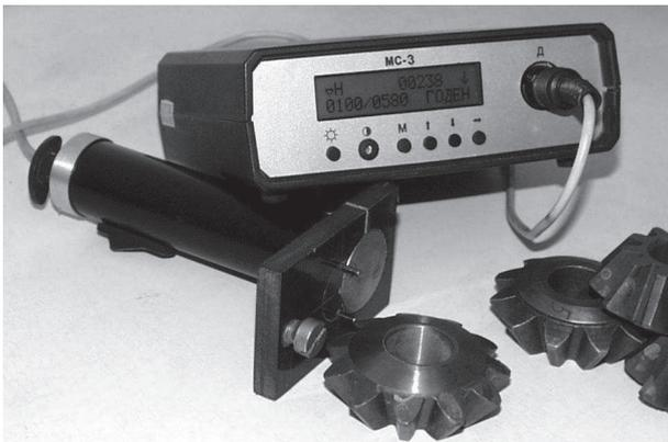
Рис. 2 Внешний вид магнитного сортировщика МС
