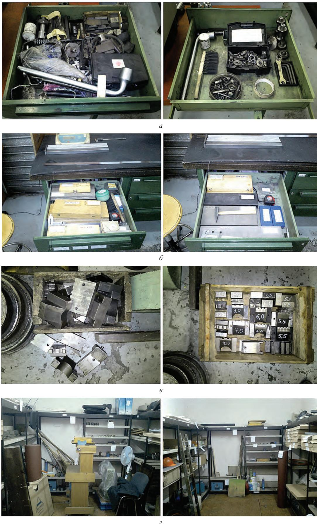
Рис. 1. Организация рабочего места в лаборатории физико-механических испытаний (до и после): а, б – ящики производственного шкафа на рабочем месте; в – оснастка для высадочного прессы с отрезным устройством; г – складское помещение
