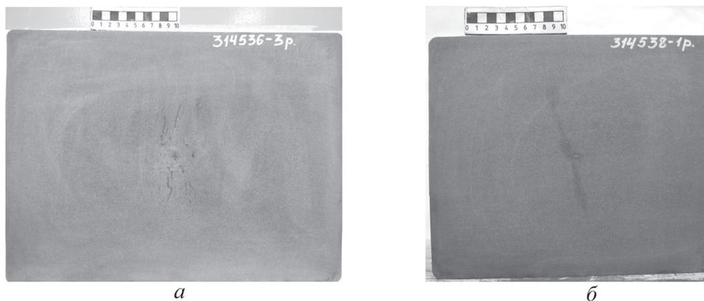
Рис. 1. Макроструктура темплета непрерывнолитой заготовки плавки сечением 300×400 (а) и 250×300 мм (б)
