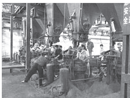
Рис. 6. Изготовление форм для производства отливок поршневых колец на встряхивающих машинах в Китае
