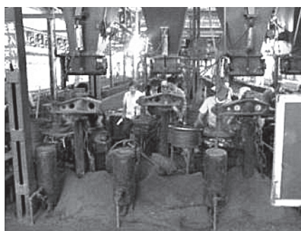
Рис. 6. Изготовление форм для производства отливок поршневых колец на встряхивающих машинах в Китае
