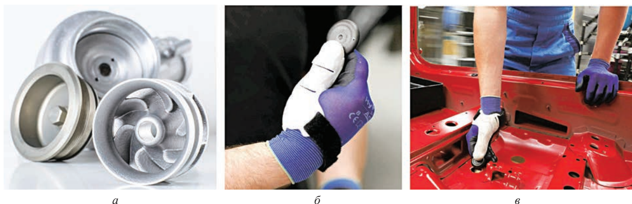
Рис. 7. Некоторые примеры использования 3D-технологии концерном BMW: а – деталь насоса; б , в – эргономичный инструмент (белого цвета) на руке работника
