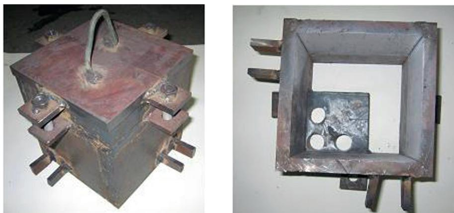
Рис. 5. Кокиль для получения цилиндрических отливок при совместной заливке шлакометаллического расплава
