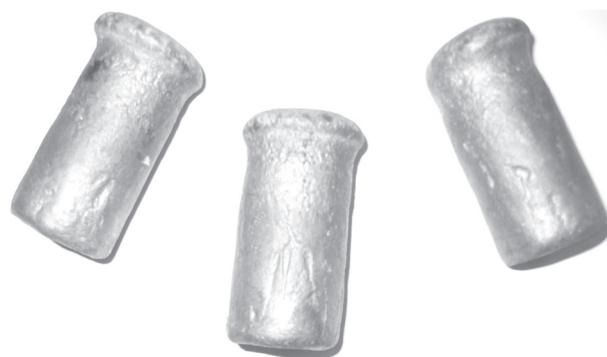
Рис. 7. Образцы из сплава на основе хрома
