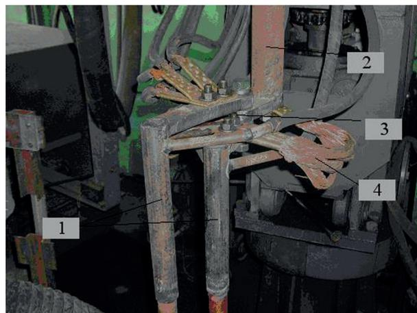
Рис. 6. Бифилярный электрододержатель: 1 – водоохлаждаемые электроды; 2 – штанга; 3 – поворотный узел; 4 – токоподводы
