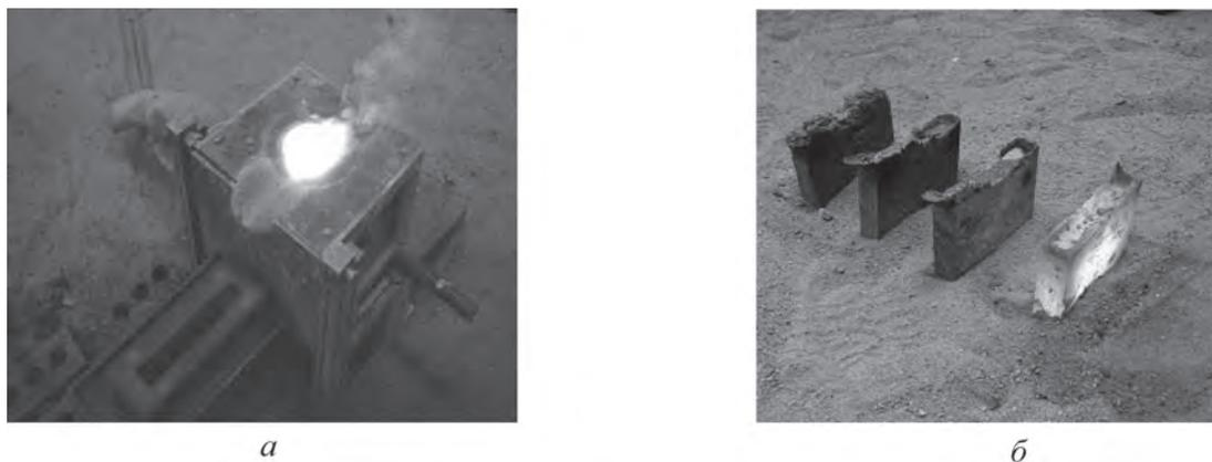
Рис. 2. Методика проведения опытных плавов (а) и общий вид полученных литых заготовок (б)
