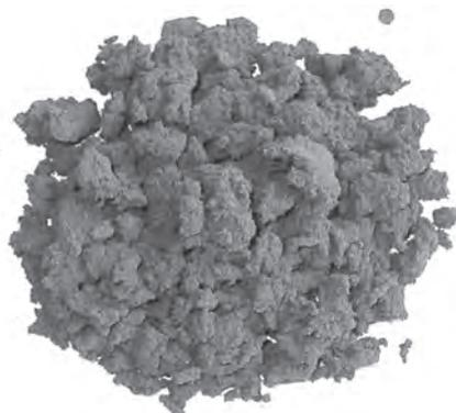
Рис. 1. Внешний вид шлифовального шлама
