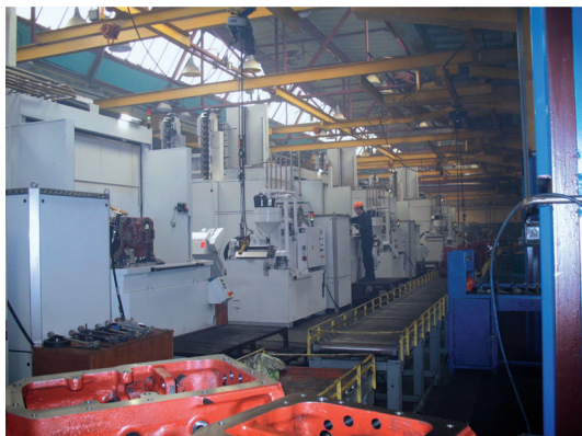
Рис. 1. Линия обработки крупногабаритных заготовок на станках SAS-TCF 2.6
