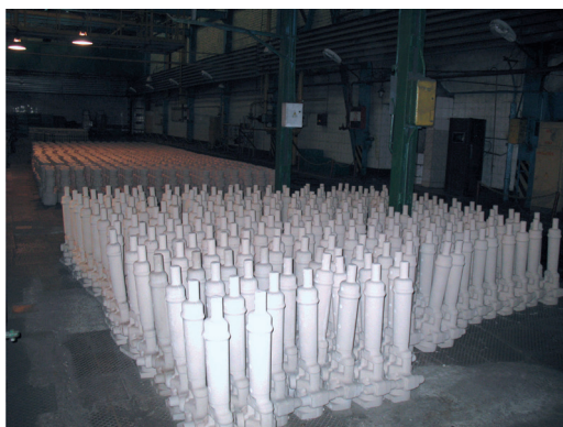
Рис. 9. Изготовление стержней по ХТС-процессу для корпусных отливок
