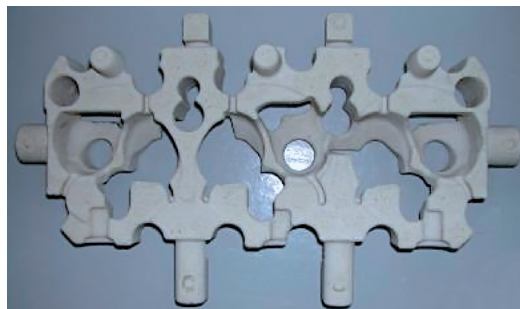
Рис. 4. Целый стержень «рубашка водяного охлаждения» отливки «головка блока цилиндров» 260-1003015
