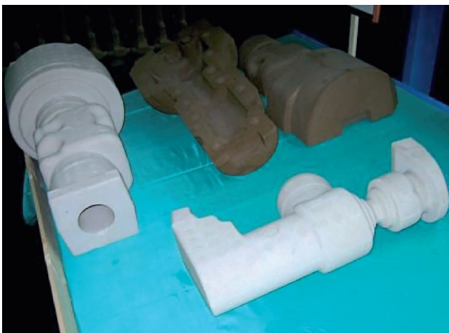
Рис. 6. Стержни отливки «картер редуктора», изготовленные по старой и новой технологиям
