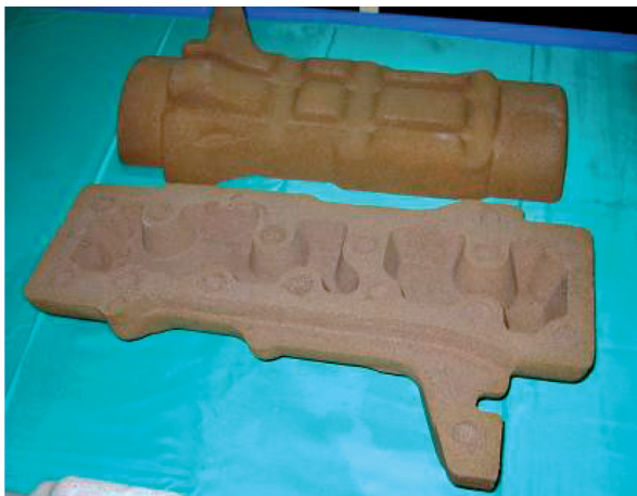
Рис. 1. Стержень отливки «рукав полуоси» 1221-2407018Б/01Б, изготовленный по старой технологии
