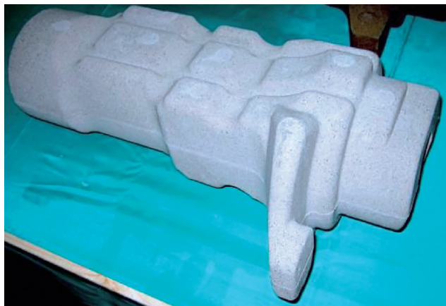
Рис. 8. Цельный стержень отливки «рукав полуоси» 1221-2407018Б/01Б, изготовленный по Амин-процессу
