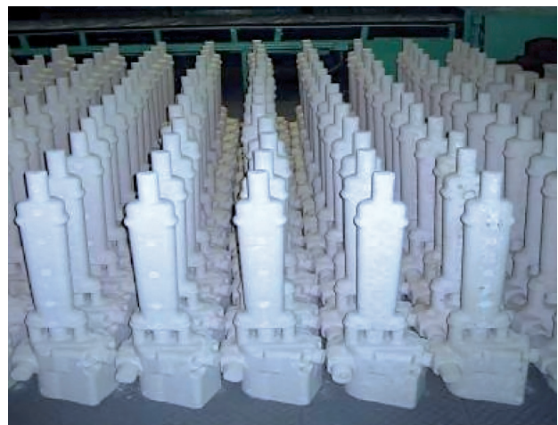
Рис. 7. Стержни отливки «гидроусилитель руля», изготовленные по Амин-процессу
