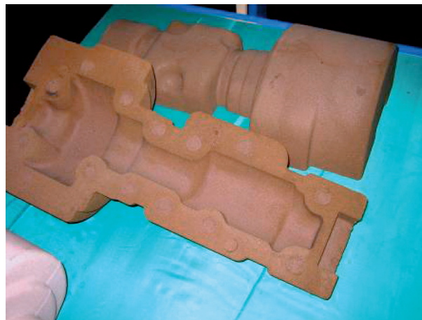
Рис. 2. Стержень отливки «рукав полуоси», изготовленный по старой технологии
