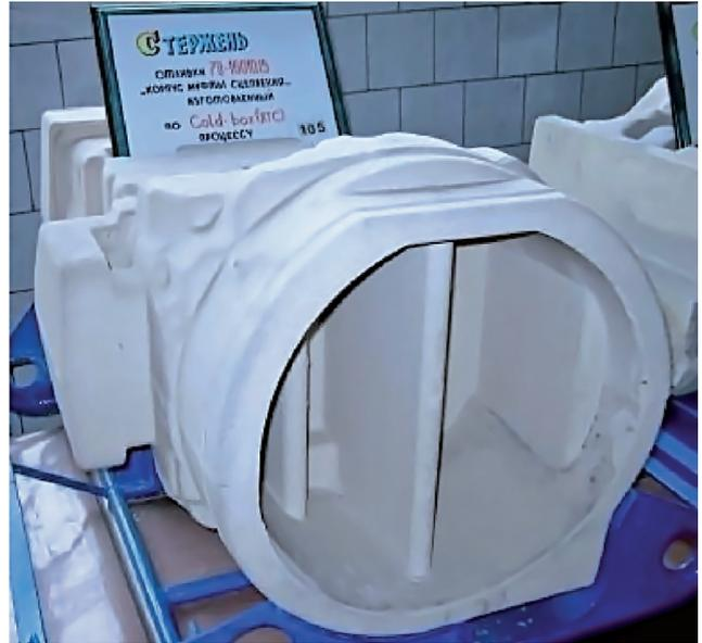
Рис. 6. Целиковый стержень отливки «корпус муфты сцепления 70-1601015», изготовленный по Амин-процессу
