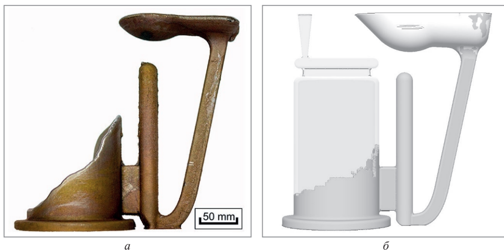
Рис. 6. Моделирование непролива при заливке алюминиевого сплава в песчаную форму: а – экспериментальные данные [1]; б – результат моделирования при аналогичных условиях
