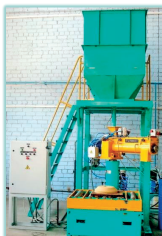
Комплекс оборудования для изготовления форм и стержней из ХТС
