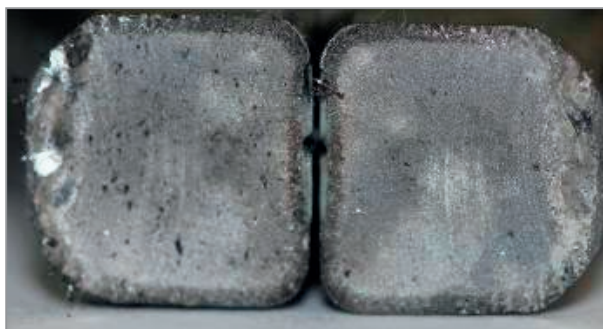
Рис. 2. Внешний вид излома звена цепи
