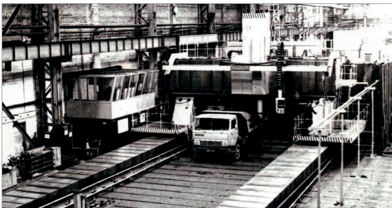
Рис. 2. Горизонтально расточной станок, длина 49 м
