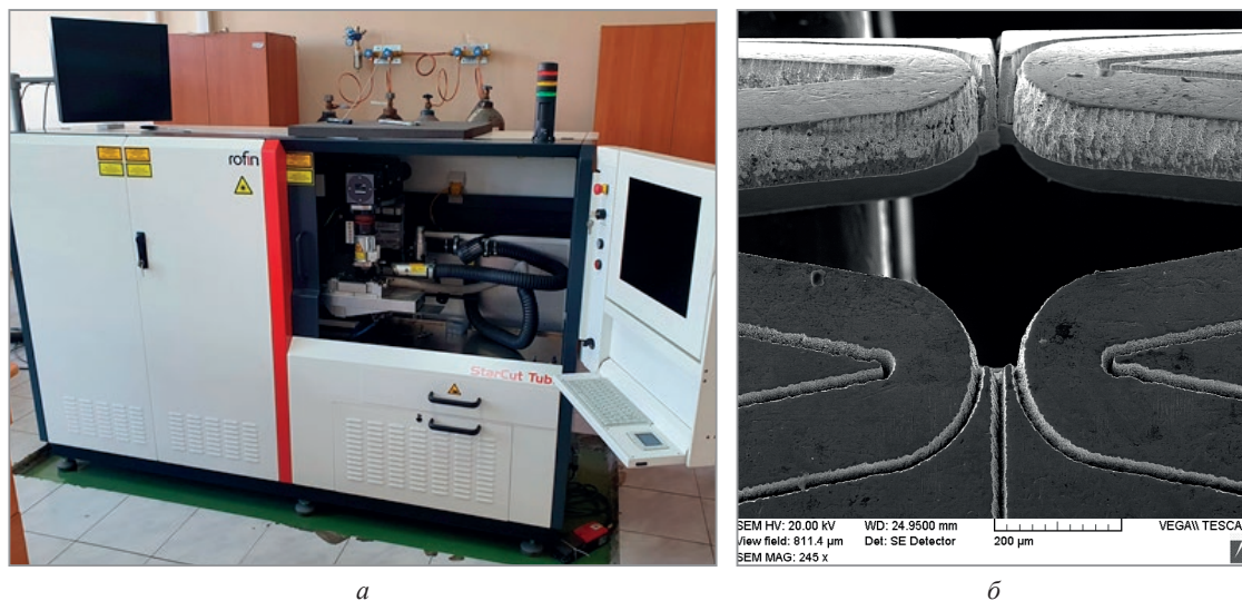
Рис. 2. Установка высокоточной лазерной резки (а) и образцы стентов (б) из Co-Cr-сплавов после лазерной резки
