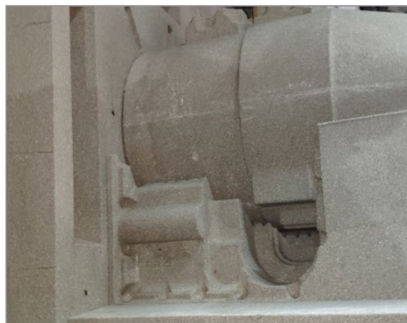
Рис. 4. Вид части формы для получения отливки детали «Картер»
