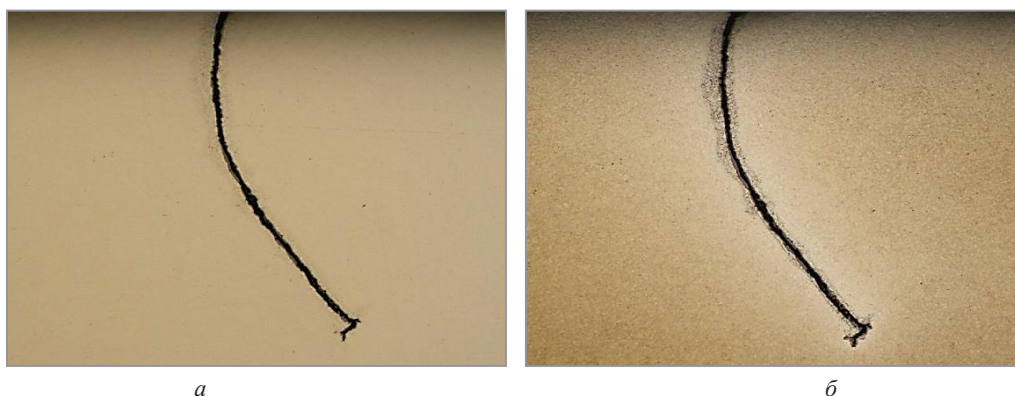
Рис. 2. Дефект в поперечном сечении микрошлифа исследуемого образца. х50: а – без травления; б – травление в реактиве «Nital»
