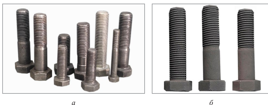
Рис. 1. Внешний вид образцов до цинкования (а) и после проведения термодиффузионного цинкования в порошковой смеси на основе гартцинка (б)
