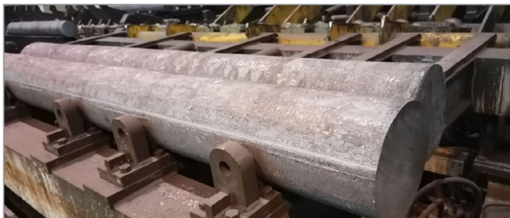
Рис. 5. Риска на непрерывнолитой заготовке
