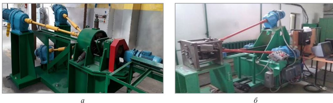
Рис. 1. Используемые радиально-сдвиговые станы: а – РСП 14/40 (ЧПУ, г. Ченстохова, Польша); б – РСП 10/30 (КГИУ, г. Темиртау, Казахстан)
