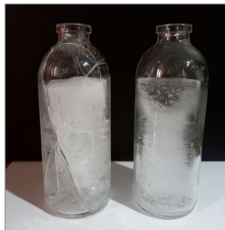
Рис. 2. Отливки из льда, затвердевшие в морозильной камере при 253 К: левая – без теплоизоляции верхней части бутылки с водой; правая – с теплоизоляцией верхней части бутылки с водой
