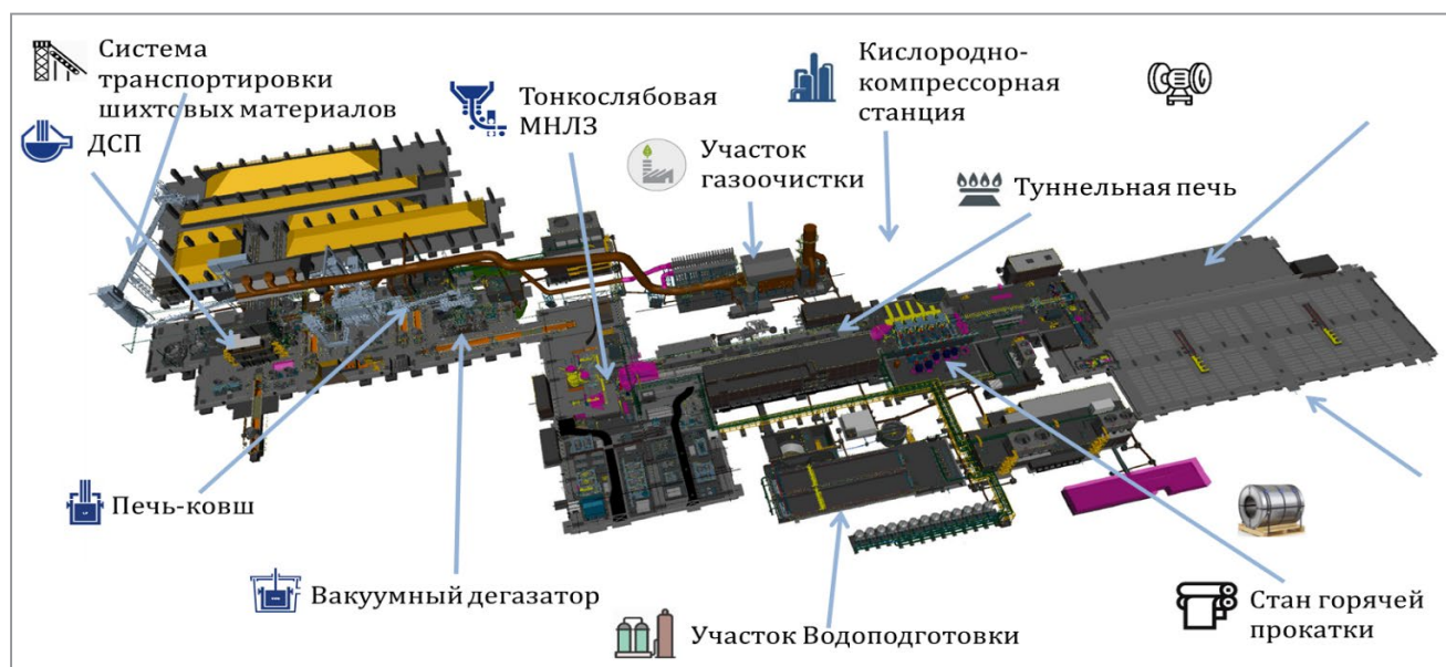
Рис. 3. Основные технологические участки и агрегаты «Литейно-прокатного комплекса»
