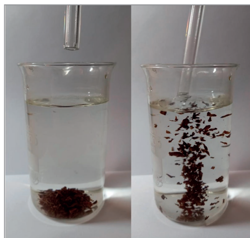
Рис. 4. Вихревое движение частиц тяжелее воды при ее вращении в стеклянном стакане
