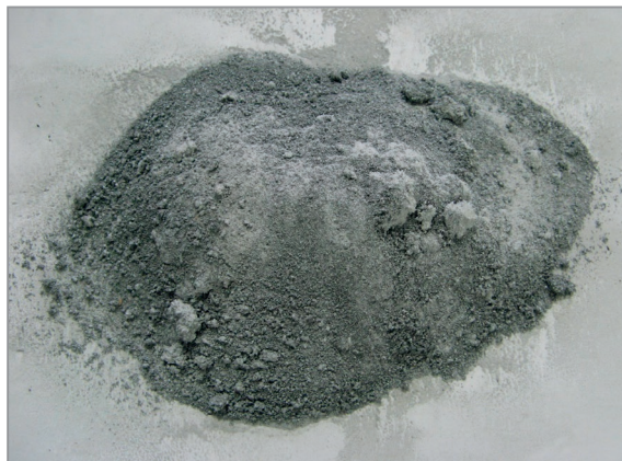
Рис. 4. Внешний вид смеси, содержащей 80 % Zn_{ст} после проведения термодиффузионного цинкования стальных образцов при температуре 450 °C
