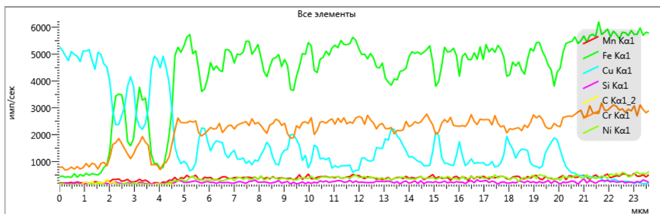
Рис. 9. Анализ концентраций Mn, Fe, Cu, Si, C, Cr и Ni как исходных элементов структуры после выполнения прошивки зоны сварки и создания дефектов прошивки
