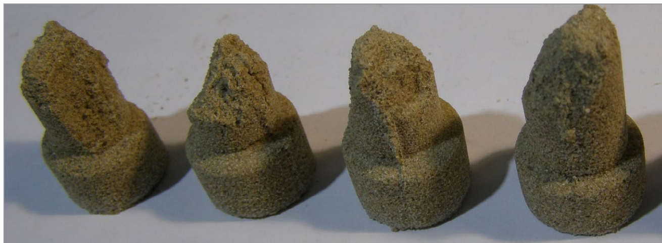
Рис. 1. Форма сколов на образцах песчано-жидкостекольных литейных стержней цилиндрической формы после испытаний на предел прочности при сжатии
