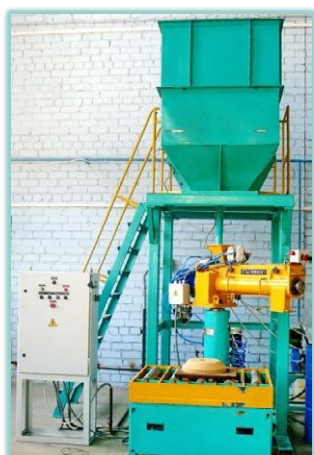
Комплекс оборудования для изготовления форм и стержней из ХТС
