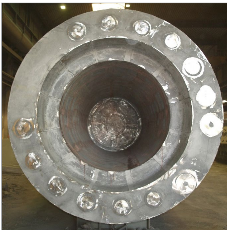
Рис. 6. Выбитая отливка со следами применяемых холодильников
