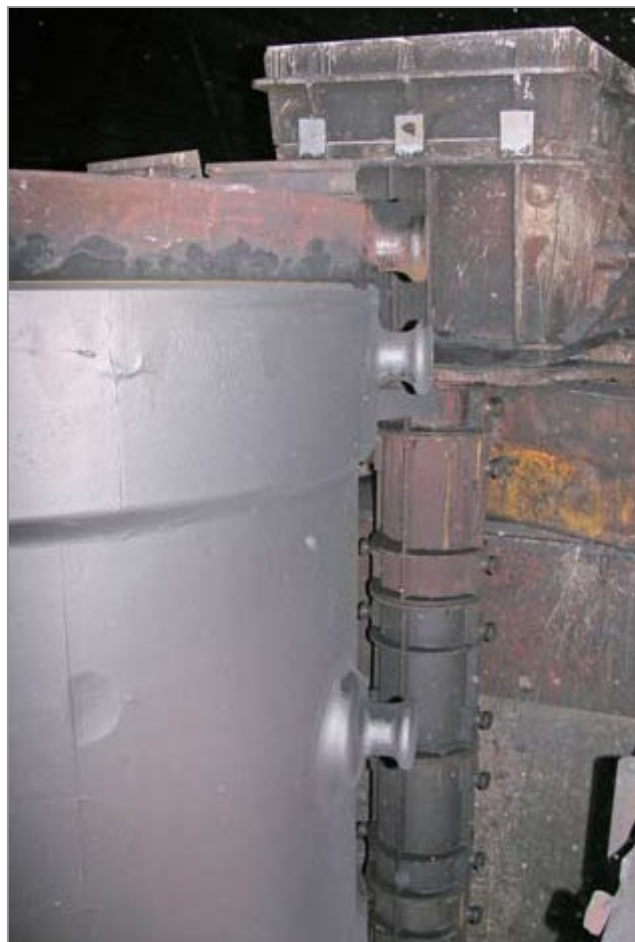
Рис. 4. Собранный форма из кокилей, верхней опоки и стоек из керамических втулок в металлических защитных обечайках и заливочные чаши
