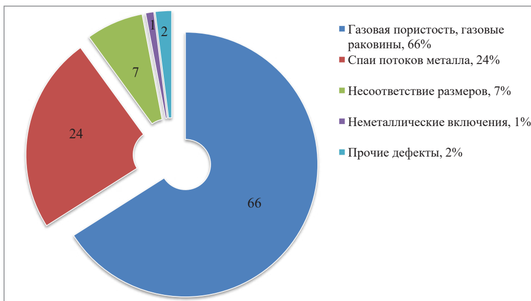
Рис. 1. Распределение различных видов брака отливок при ЛПД
