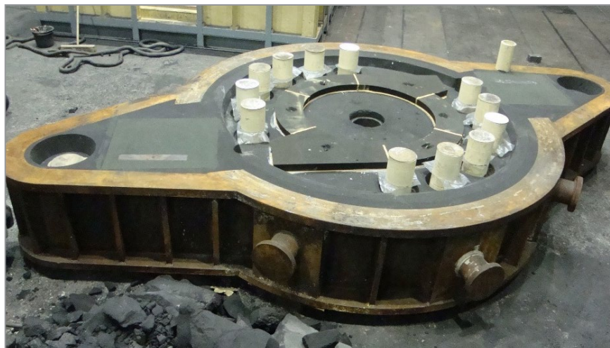
Рис. 2. Базовая конструкция формы с литниковой системой
