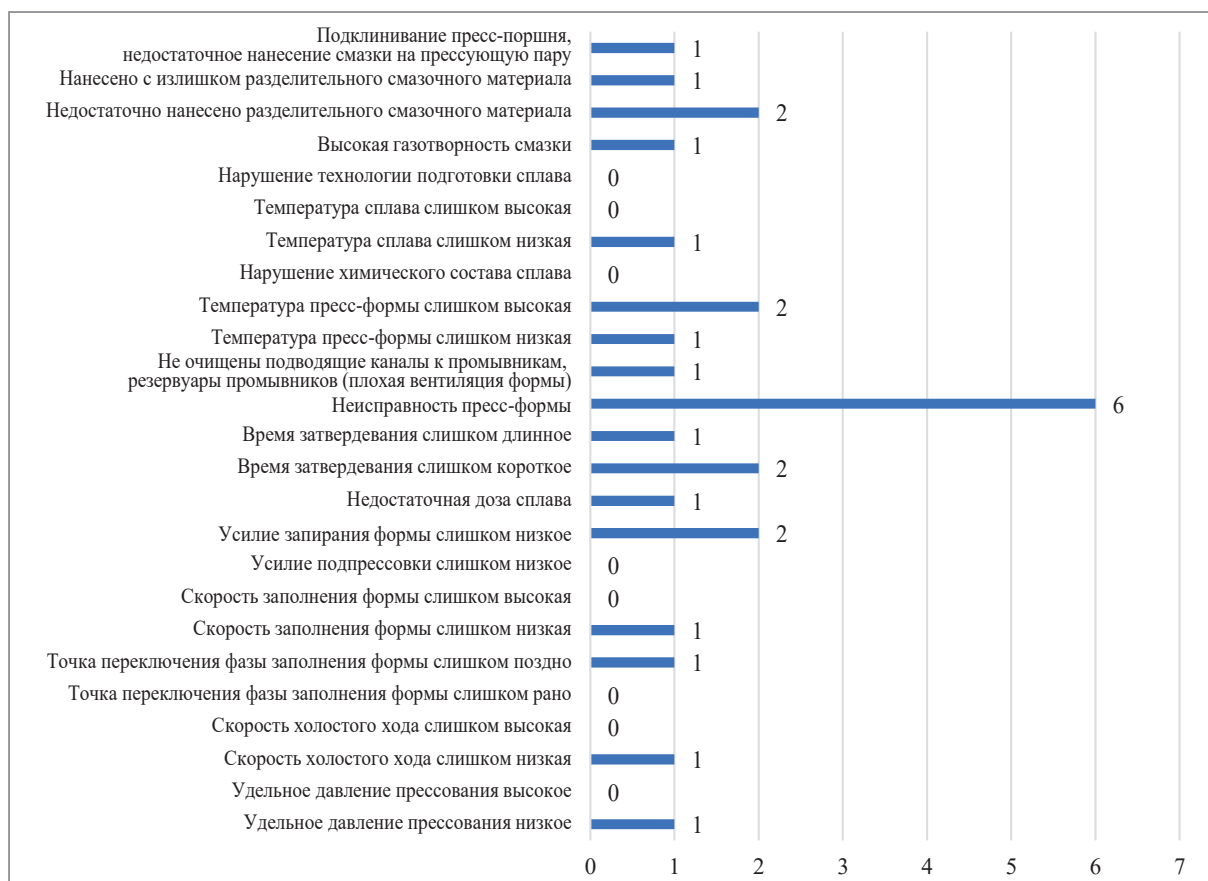
Рис. 3. Количество возможных видов дефектов, проявляющихся как неточности геометрии отливок, по различным причинам при ЛПД
