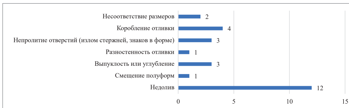
Рис. 6. Количество возможных причин образования дефектов несоответствия отливок по геометрии при ЛПД
