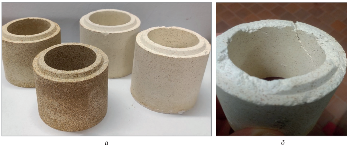
Рис. 1. Образцы керамики, полученные на основе разработанного состава: а – образцы с использованием глины «Крупейский сад» (Республика Беларусь); б – образцы с использованием глины «Веселовская» (Украина)
