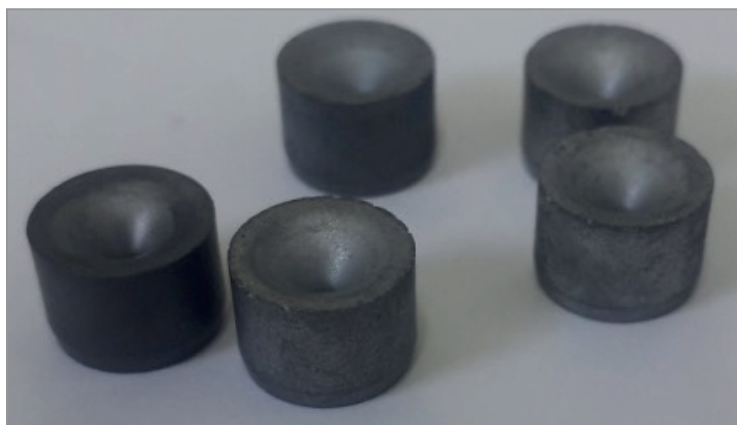
Рис. 2. Твердосплавные волоки-заготовки типоразмером 9×6 мм
