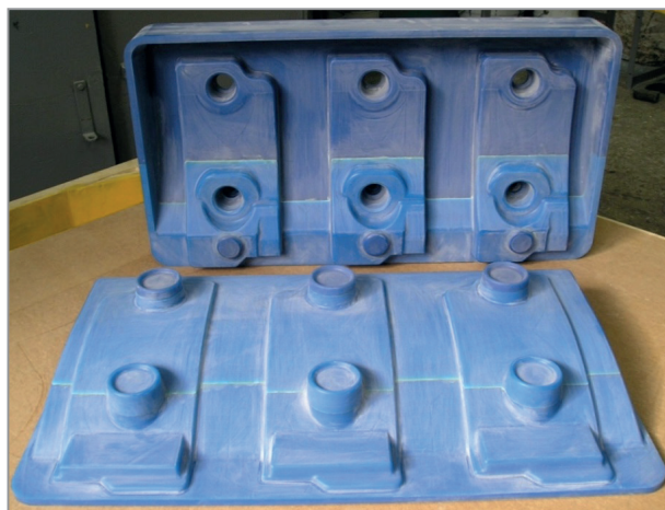
Рис. 4. Склеенный пластиковый МК для автоматической формовочной линии
