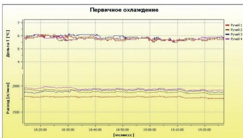
Рис. 5. Параметр  $\Delta T$  при использовании двух- и трехконусных гильз кристаллизаторов
