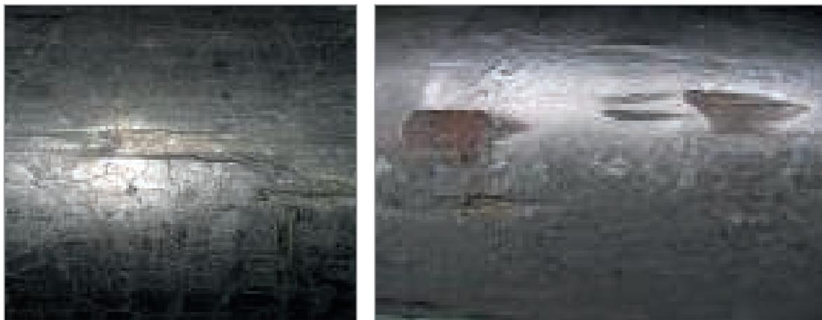
Рис. 2. Дефекты на наружной поверхности раскатной оправки диаметром 116,1 мм после 175 проходов
