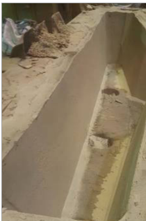
Рис. 3. Пятый промежуточный ковш с рабочей футеровкой из сухой массы
