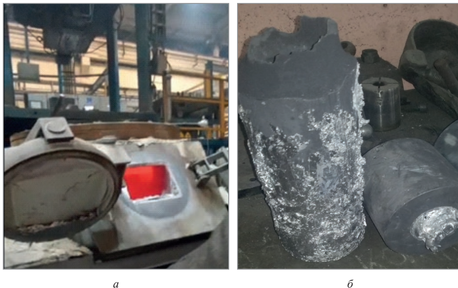
Рис. 1. Использование тепловых агрегатов в производственных условиях при изготовлении изделий из сплавов алюминия (а), а также вид внутренних элементов печи (б), выполненных из графита, после недолговременной эксплуатации (менее 1 мес)
