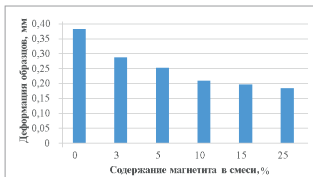
Рис. 10. Высокотемпературная деформация образцов, изготовленных по Furan -процессу
