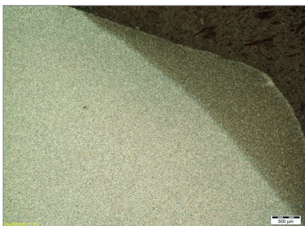
Рис. 8. Кольцо самоотпуска: а – режим № 1 для арматурного проката номинальным диаметром 8 и 10 мм класса прочности А500С. \times 100 ; б – режим № 2 для арматурного проката номинальным диаметром 8 и 10 мм класса прочности А500С. \times 100
