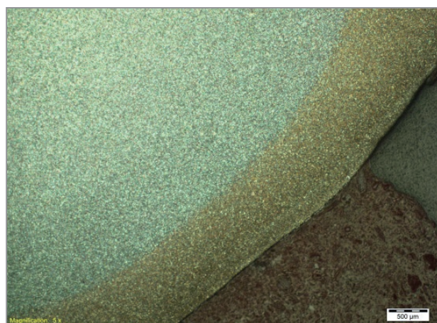
Рис. 8. Кольцо самоотпуска: а – режим № 1 для арматурного проката номинальным диаметром 8 и 10 мм класса прочности А500С. \times 100 ; б – режим № 2 для арматурного проката номинальным диаметром 8 и 10 мм класса прочности А500С. \times 100
