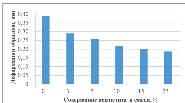
Рис. 9. Высокотемпературная деформация образцов, изготовленных по Alpha-set-процессу
