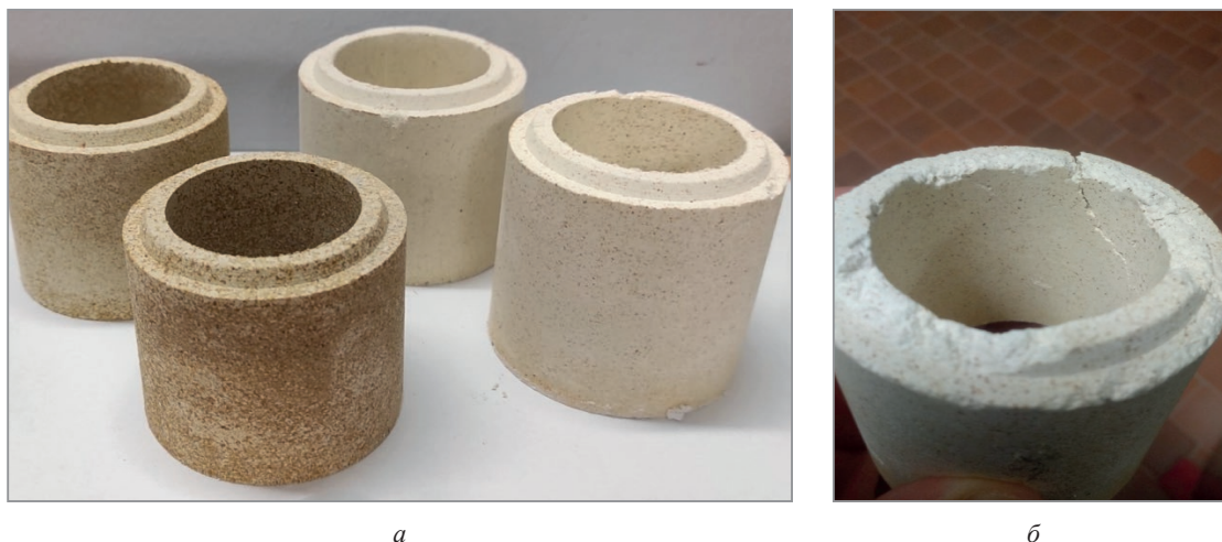
Рис. 3. Поведение волластонитсодержащей керамики при ее длительном хранении: а – образцы с использованием глины месторождения «Крупейский сад» (Республика Беларусь); б – образцы с использованием глины месторождения «Веселовское» (Украина)
