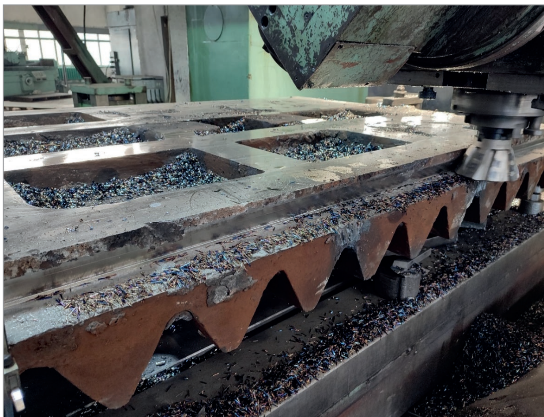
Рис. 14. Плита после механической обработки (вид сбоку)
