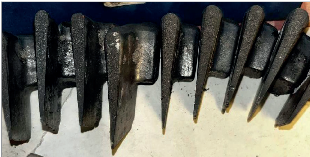
Рис. 2. Клиновые пробы после модифицирования смесью УККС-45-А
