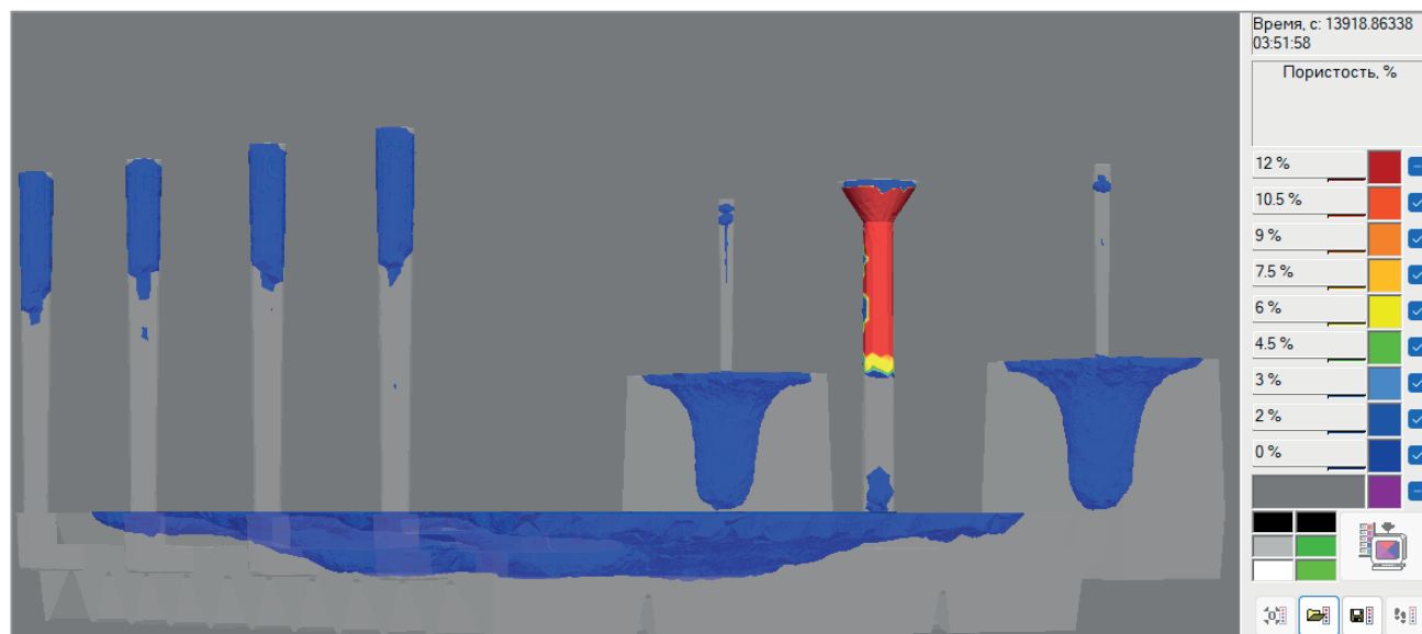
Рис. 9. Вероятные места образования усадочной пористости в пределах 2%
