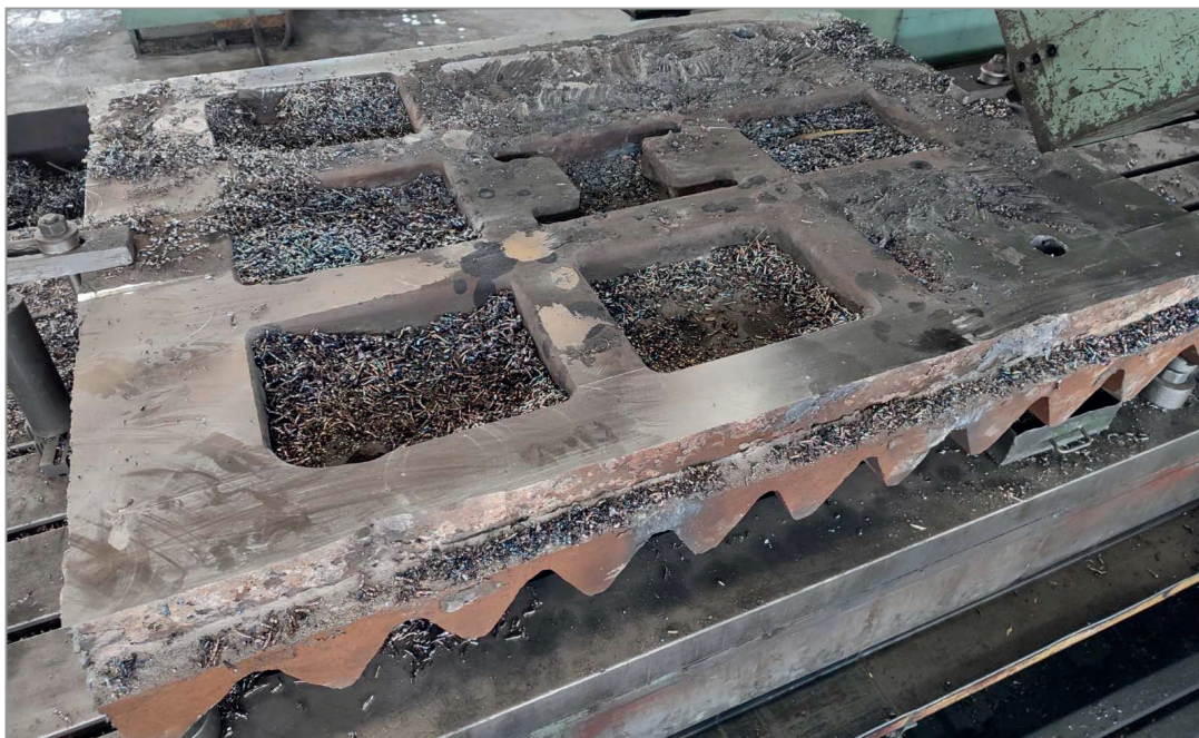
Рис. 15. Плита после механической обработки (вид сверху)
