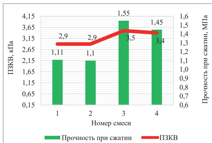
Рис. 1. Изменение прочности образцов ПГС
