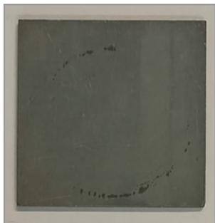
Образец с цинковым покрытием на базе порошкового Zn, полученным в установке диффузионного цинкования с вращающейся ретортой, в системе 50% Zn<sub>ст</sub> + 49% Al<sub>2</sub>O<sub>3</sub> + 1% NH<sub>4</sub>Cl
