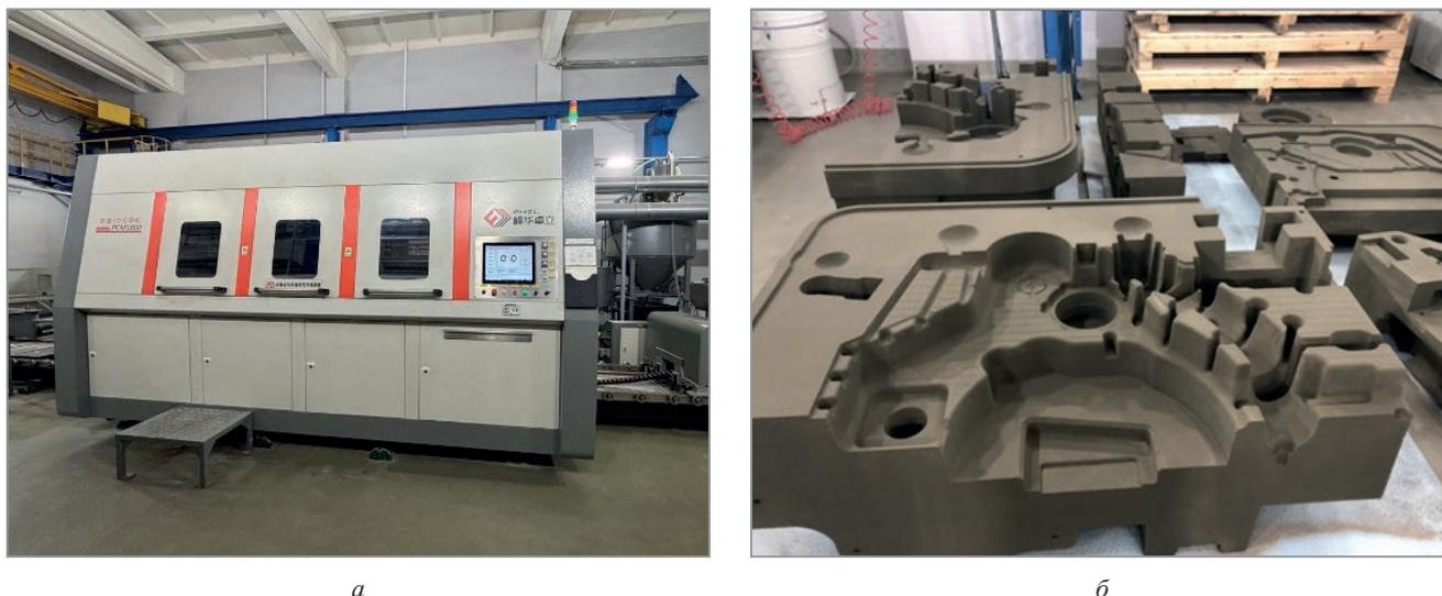
Рис. 2. Комплекс для печати полимерно-песчаных форм, установленный на ОАО «УКХ «ММЗ»: а – комплекс для печати; б – напечатанные на данном комплексе литейные формы и стержни
