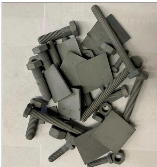
Рис. 2. Металлоизделия и пластины после нанесения цинкового покрытия
