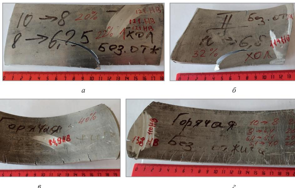
Рис. 3. Результаты прокатки литых (отожженных) образцов при КГН 500g из АМг5 в зависимости от суммарной степени обжатия и количества проходов (табл. 2):
