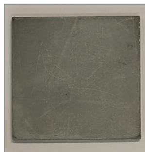
Образец с цинковым + хроматным покрытием на базе цинковой пыли
