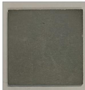
Образец с цинковым покрытием на базе цинковой пыли, полученным в установке диффузионного цинкования с вращающейся ретортой, в системе 50% Zn<sub>отх</sub> + 49,9% Al<sub>2</sub>O<sub>3</sub> + 0,1% изгарь – отход горячего цинкования
