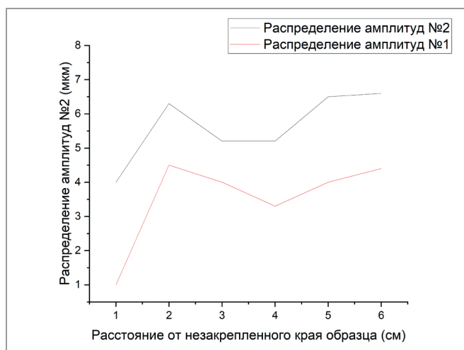
Рис. 3. Распределение амплитуд ультразвуковых колебаний по длине подложки
