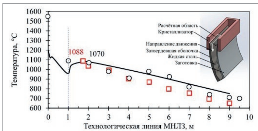
Изменение температуры поверхности заготовки вдоль технологической линии МНЛЗ:
