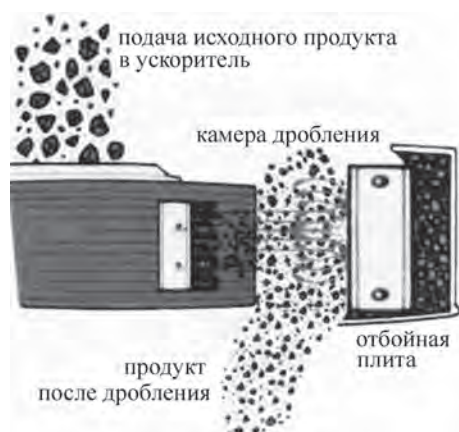
Рис. 3. Схема устройства для центробежно-ударного дробления минеральных материалов
