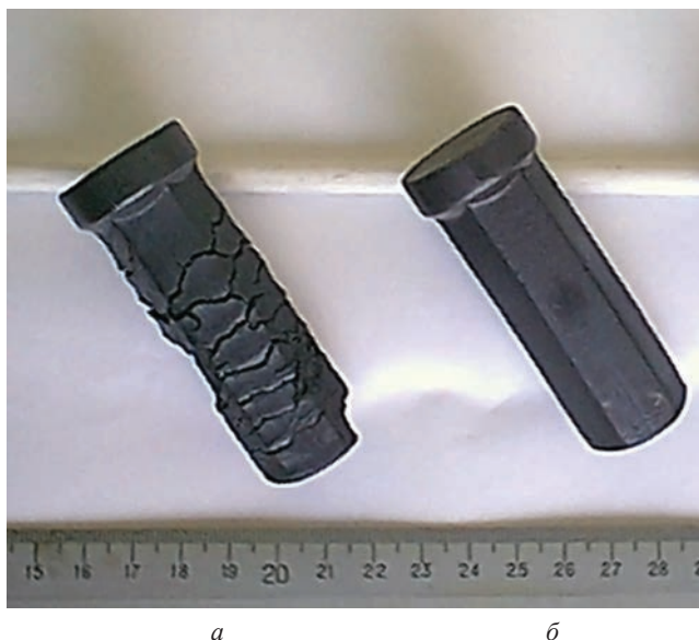
Рис. 1. Заготовка детали «цилиндр нагнетательного плунжера домкрата грузового автомобиля» в виде шестигранного прутка, полученная из цилиндрической заготовки высокопрочного чугуна горячим выдавливанием: а – с нарушением параметров технологии (дефект, так называемый «ерш» – множество надрывов на поверхности); б – при оптимальных параметрах деформации
