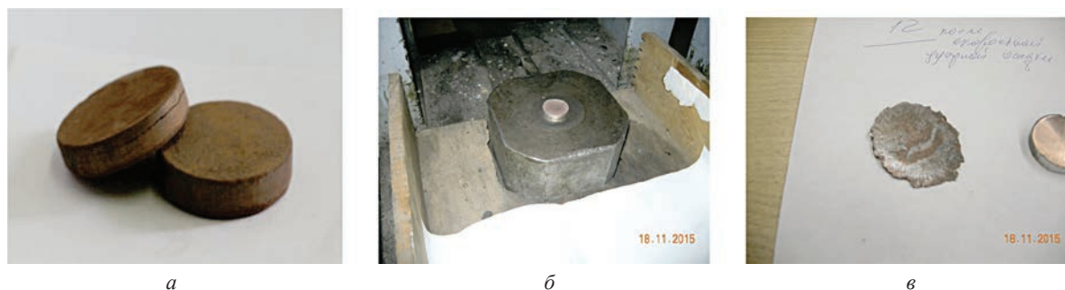
Рис. 2. Исходный брикет лигатуры (а); наковальня для высокоскоростной ударной деформации (б); полученная «чипс»-лигатура (в)
