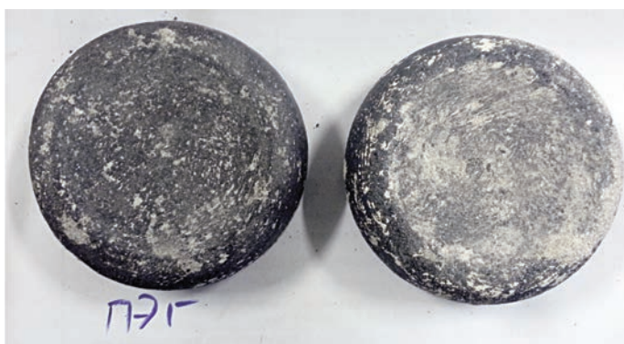
Рис. 2. Внешний вид торцевой поверхности отливок: а – краска с добавкой; б – заводская краска
