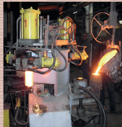
установка непрерывно- циклического литья намораживанием
