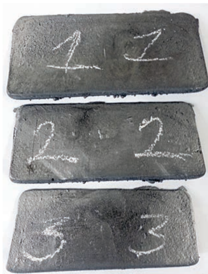
Рис. 4. Внешний вид отливок
