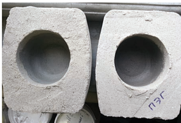
Рис. 1. Внешний вид форм: а – заводская краска; б – краска с добавкой
