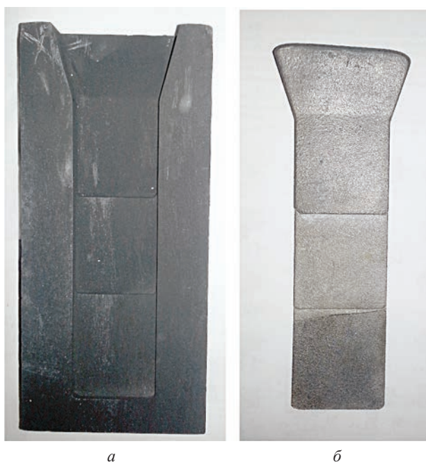
Рис. 3. Отливки в кокиле: а – кокиль после извлечения отливки; б – внешний вид отливки
