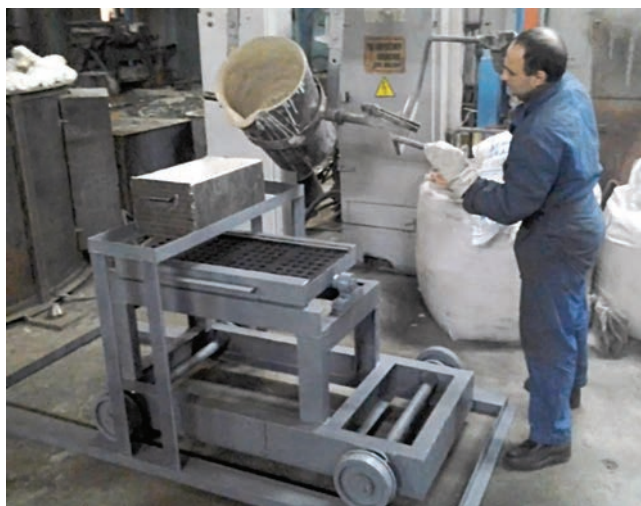
Рис. 4. Экспериментальная установка для литья мелющих тел
