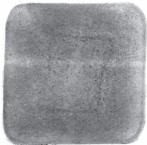
Рис. 1. Поперечное сечение заготовки клетей 125×125 мм
