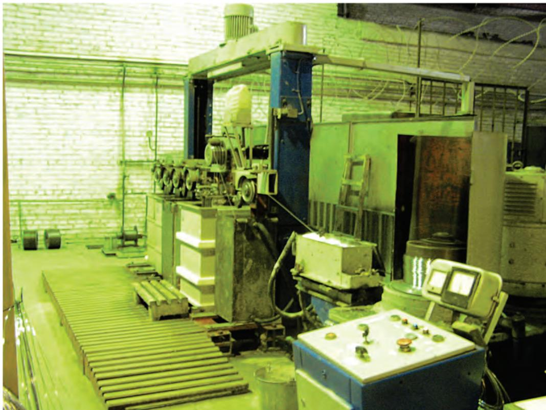
Рис. 2. Малогабаритная установка скоростного гальванического цинкования проволоки
