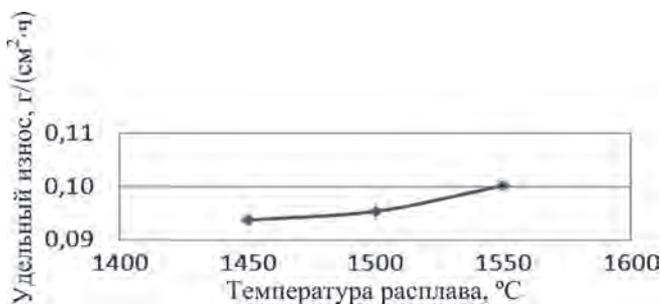
Рис. 3. Влияние температуры расплава на износостойкость
