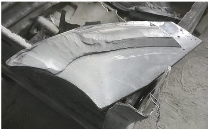
Рис. 5. Характерный износ детали «подкладной лист»
