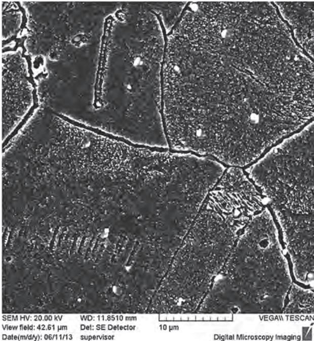
Рис. 4. Структура литой классической бронзы БрХ
