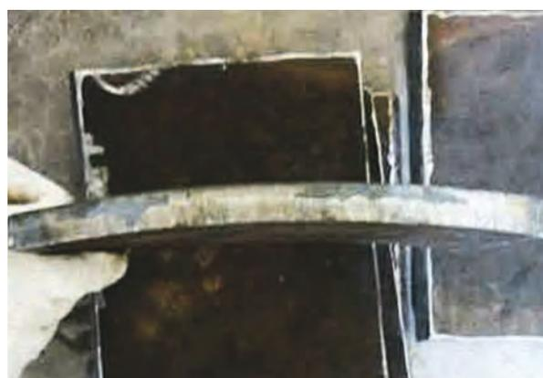
Рис. 2. Исходные образцы трубы из стали 10Г2БФ
