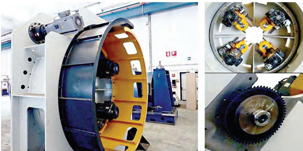
Рис. 3. Машина для резки трубы на кольцевую заготовку
