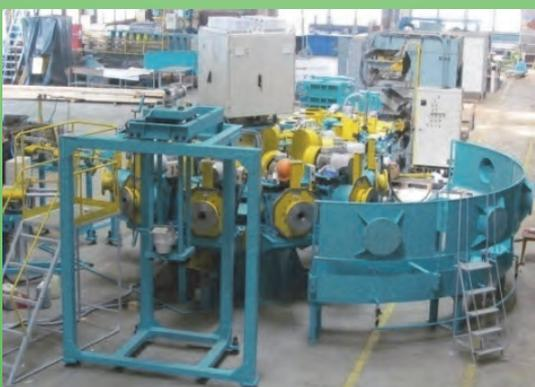
Комплекс оборудования для производства отливок гильз мод.49105
