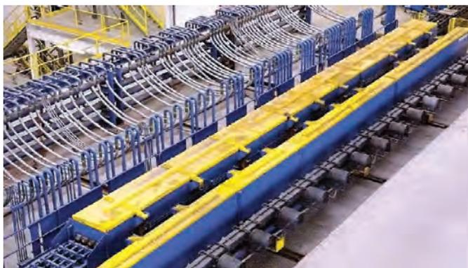
Рис. 9. Установка ускоренной термической обработки прутков
