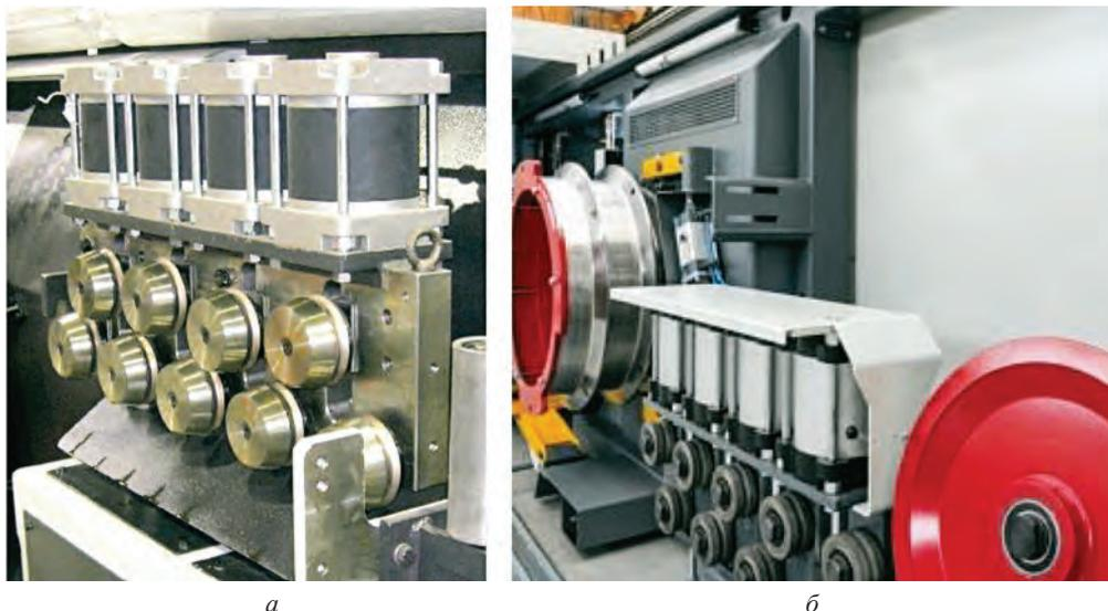
Рис. 3. Рихтовальное устройство станов холодной прокатки фирмы «Promostar S.r.l.» (а)<sup>1</sup>; «Eurolls S.p.A.» (б)<sup>2</sup>
