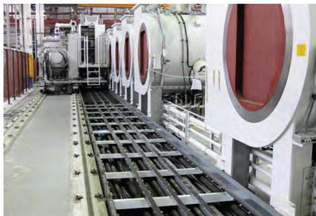
Рис. 2. Общий вид линии вакуумных печей «ModulTherm 7/1»
