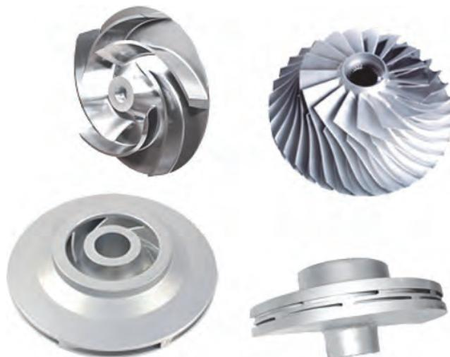
Рис. 1. Примеры отливок, изготавливаемых методом точного литья в керамическую форму
