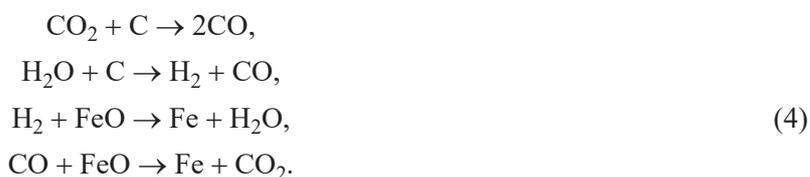
Балансовую реакцию можно записать к ( $\text{H}_2\text{O}$ ) следующим образом:
