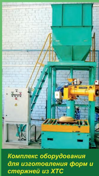
Комплекс оборудования для изготовления форм и стержней из ХТС
