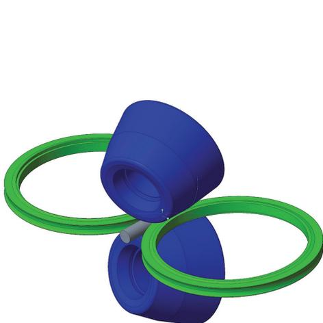
Рис. 4. Схема прошивки в стане Дишера
