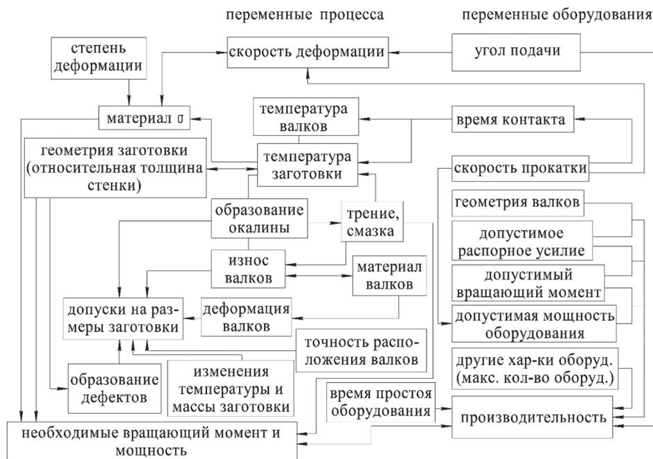
Рис. 1. Схема взаимосвязи факторов, определяющих режим обработки
