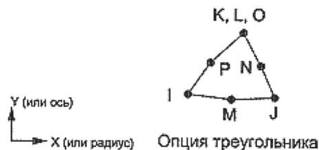
Рис. 4. Геометрия двумерного (2D) элемента, расположение узлов и системы координат элемента:  $I, J, L, K, M, N, O, P$  – узлы
