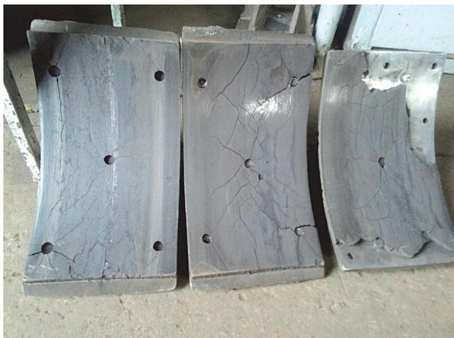
Рис. 1. Внешний вид разрушенных фрикционных накладок из материала марки «Трибонит TR9-01»
