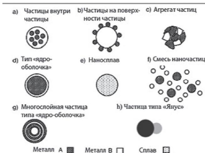
Рис. 1. Морфология биметаллических наночастиц [2]
