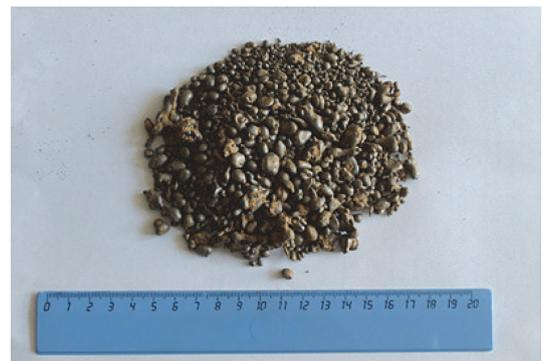
Рис. 4. Общий вид чугунных гранул
