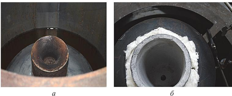
Рис. 3. Гранулятор с вертикальной осью вращения: а – гранулятор; б – теплоизолированный приемный тигель с отверстием в донной части
