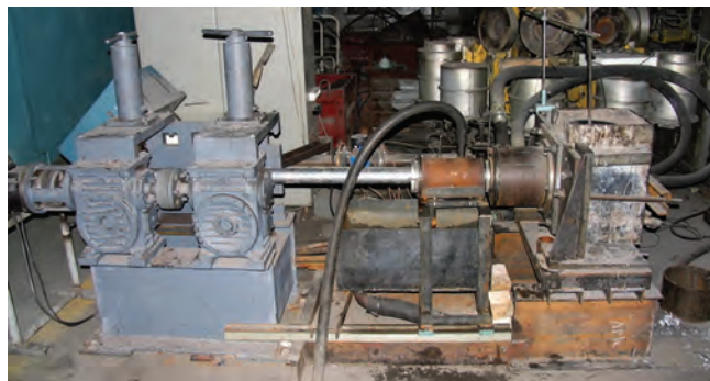
Рис. 5. Непрерывное горизонтальное литье с использованием струйного охлаждения
