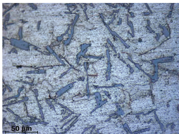
Рис. 3. Микроструктура литой заготовки диаметром 50 мм из сплава Al + 12% Si + 3% Cu: а — литье в обычный (щелевой) кристаллизатор; б — литье в струйный кристаллизатор. \times 1000
