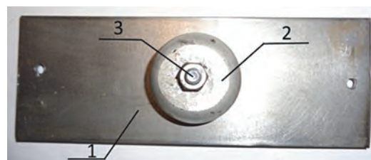
Рис. 1. Протектор и защищаемый стальной образец: 1 – защищаемый стальной образец; 2 – протектор; 3 – болтовое соединение
