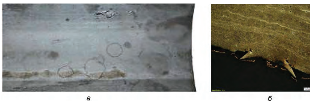
Рис. 2. Сталеплавильные плены на внутренней поверхности бесшовных труб: а – тело трубы; б – микрошлиф, травленный в реактиве Обергоффера
