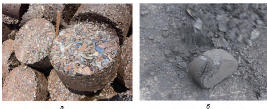
Рис. 5. Брикеты холодного прессования: а – брикеты из смешанной стружки; б – разрушение брикетов при перегрузках
