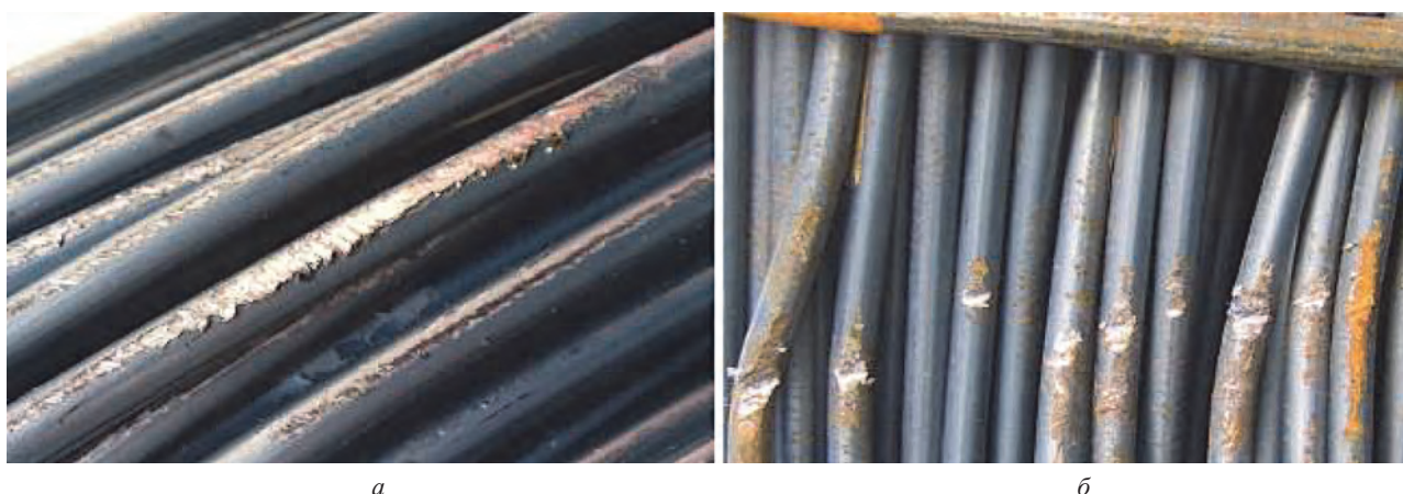
Рис. 2. Дефекты транспортировки бунтов катанки диаметром 5,5 мм
