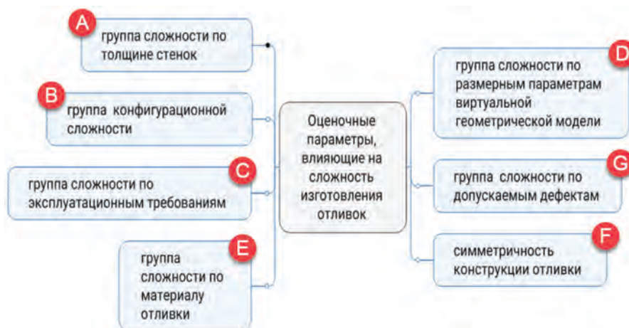
Рис. 1. Группы параметров оценки технологической сложности отливки/литейной технологии
