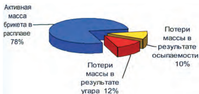
Рис. 6. Эффективность использования холоднопрессованных брикетов при плавке
