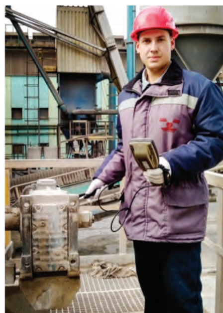
Рис. 10. Выполнение контроля состояния подшипников входного вала редуктора КА-90 прибором Leonova infiniti инженером бюро МиТД сталеплавильного производства УОриТД ОАО «БМЗ – управляющая компания холдинга «БМК»
