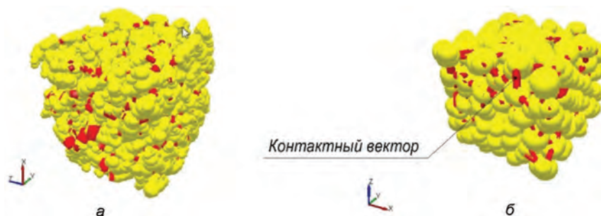
Рис. 4. Фрагменты моделей стержневой смеси в уплотненном состоянии зерен песка фракции 02: а – с применением угловатых зерен песка; б – с применением округлых зерен песка
