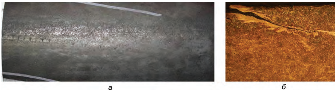
Рис. 1. Сталеплавильные плены на наружной поверхности бесшовных труб: а – тело трубы; б – микрошлиф, травленный в реактиве Обергоффера
