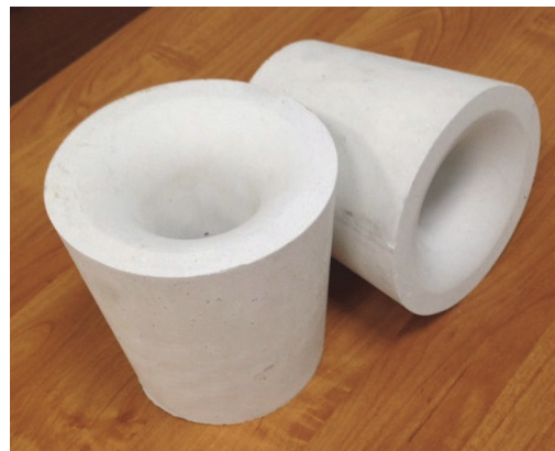
Рис. 4. Стаканы-дозаторы стопорных ковшей
