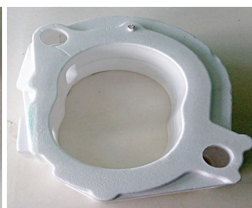
Рис. 4. Пресс-формы для изготовления пеномоделей осевых стержней: a – 3D-модель раскрытой пресс-формы и осевых стержней; б – изготовленные образцы пресс-форм
