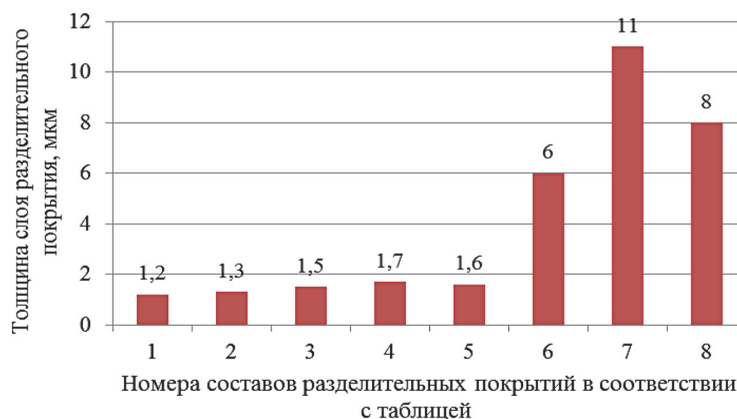
Рис. 4. Толщина слоя разделительного покрытия в зоне литника после удаления отливки из полости пресс-формы (скорость прессования 0,6 м/с)
