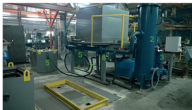
Рис. 3. Формовочно-заливочный участок: а – схема; б – фотография: 1 – сменный раздаточный бункер; 2 – вакуумный аккумулятор; 3 – вакуумный водокольцевой насос; 4 – прямой; 5 – опки под монорельсом заливочного ковша; 6 – опка на вибростол; 7 – вибростол; 8 – стенд вакуумирования
