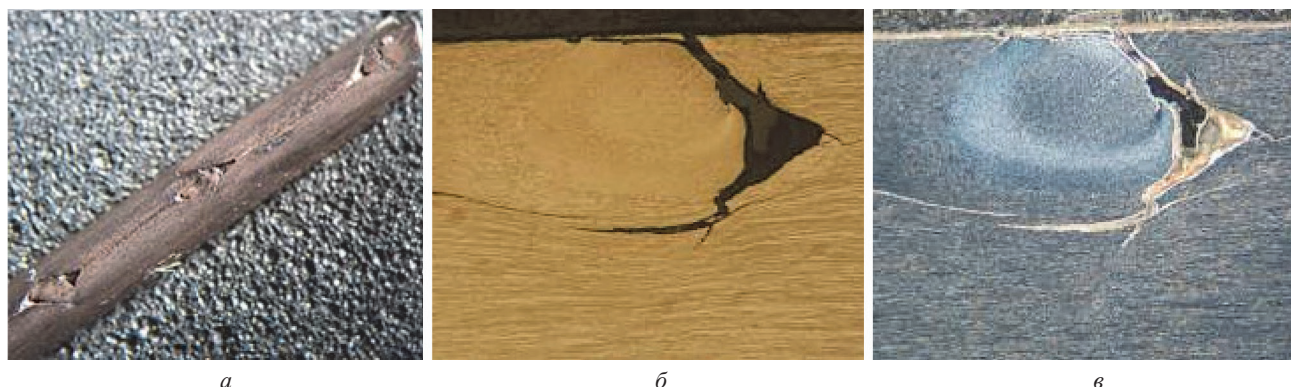
Рис. 5. Внешний вид (а) и микроструктура (б, в) обрыва проволоки по причине искрения в процессе нагрева под сварку: б – продольное сечение проволоки в зоне искрения, трещины по структуре мартенсита, светлое поле, травление в реактиве «Нитал»; в – зернистый цементит в переходном слое на границе мартенсит-перлит, темное поле, травление в реактиве «Нитал»
