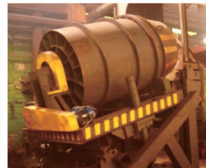
Запуск ротационной наклоняющейся печи для переработки чугуной стружки (ГЛЗ «Центролит», 2008 г.)
