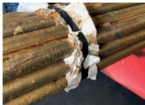
Рис. 1. Внешний вид проката при попадании атмосферной влаги на поверхность
