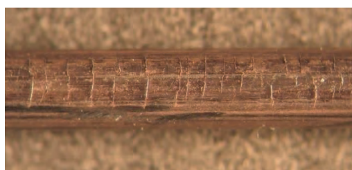
Рис. 9. Поверхностный дефект проволоки – поперечные трещины
