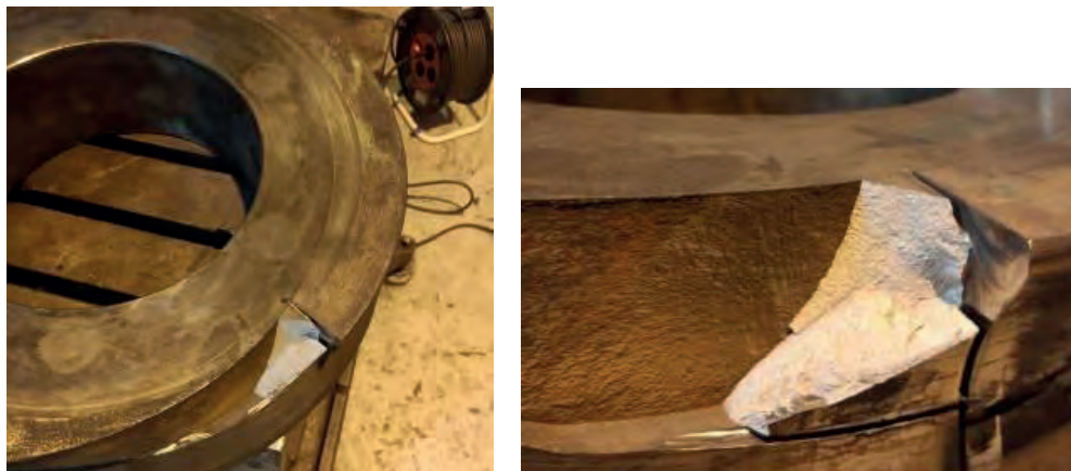
Рис. 1. Внешний вид разрушенной детали и характер разрушения
