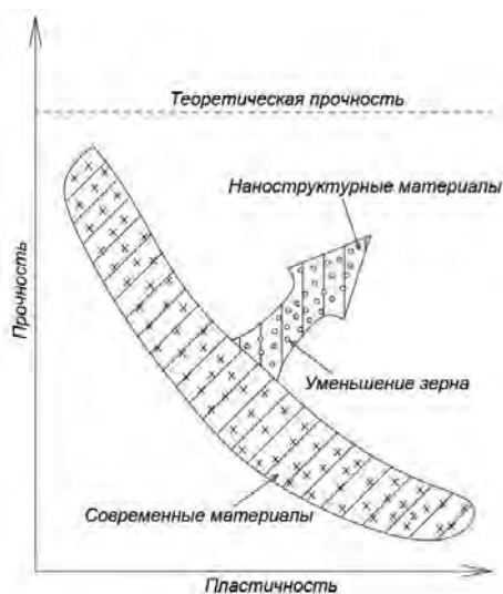
Рис. 1. Влияние размера наноструктурных элементов на изменение прочности и пластичности сплавов
