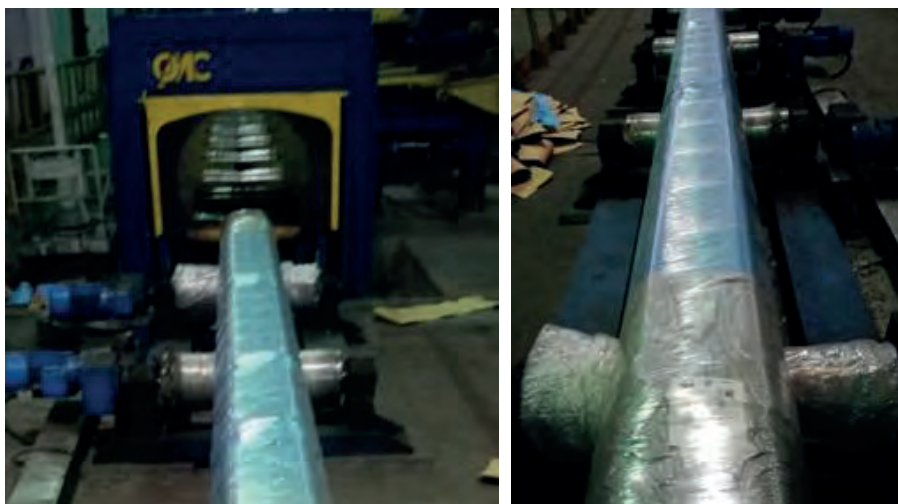
Рис. 5. Упаковка проката опытным материалом с летучим ингибитором коррозии
