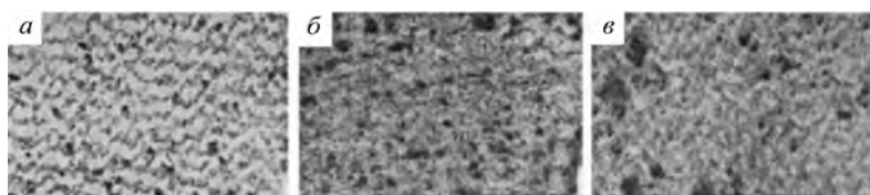
Рис. 4. Микроструктура свинцовых отливок, облученных генератором ротационного типа: а – по схеме рис. 2, а; б – по схеме рис. 2, б; в – контрольный, необлученный материал, \times 50
