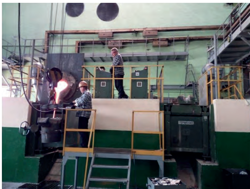
Рис. 1. Индукционные плавильные печи ИТПЭ-0,8/0,4 ТГ1
