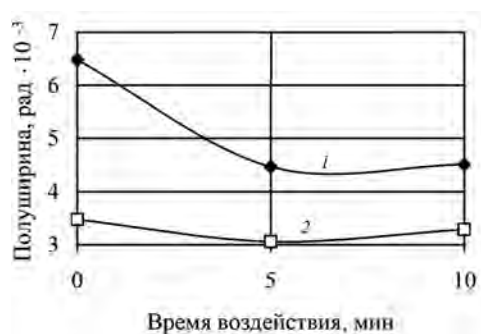
Рис. 4. Изменение полуширины линий (311) (1) и (111) (2) электролитического никеля после воздействия плазмы
