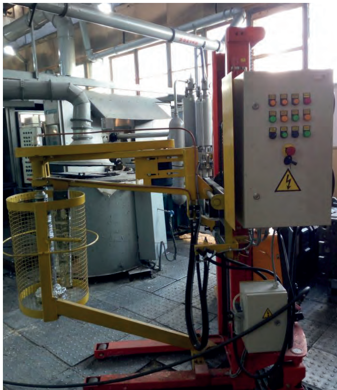
Рис. 2. Установка роторной дегазации сплава П1920
