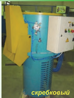
Комплекс оборудования для изготовления форм и стержней из ХТС
