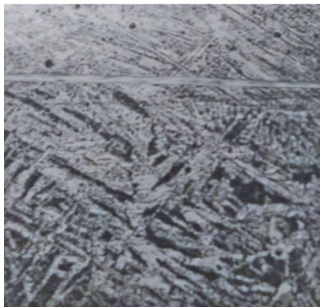
Рис. 3. Структура переходной зоны ПМКО – матрица
