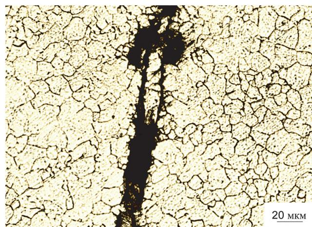
Рис. 9. Расслоение металла под действием растягивающих напряжений, возникающих на финишных стадиях термообработки.  $\times 500$
