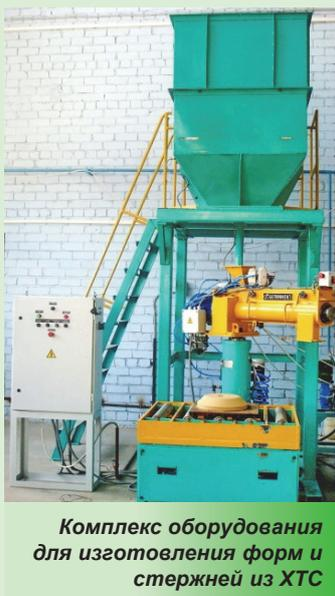
Комплекс оборудования для изготовления форм и стержней из ХТС
