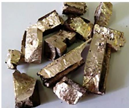
Рис. 1. Литая быстроохлажденная лигатура после измельчения
