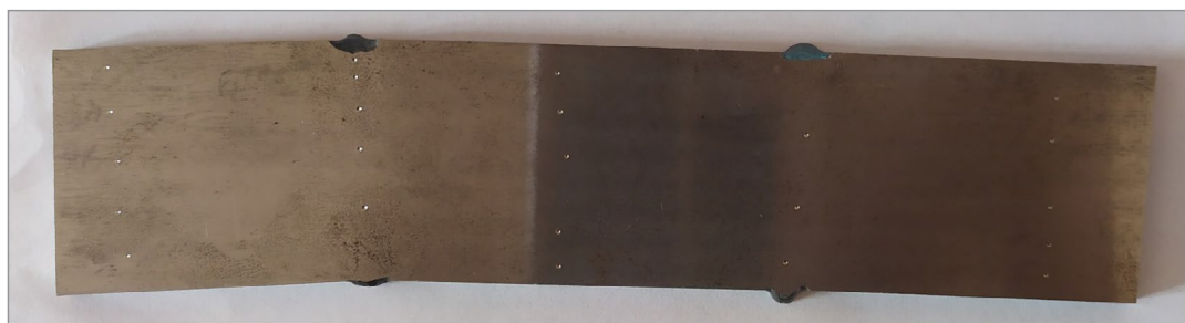
Рис. 4. Сваренный образец из стали Miilux Protection 500
