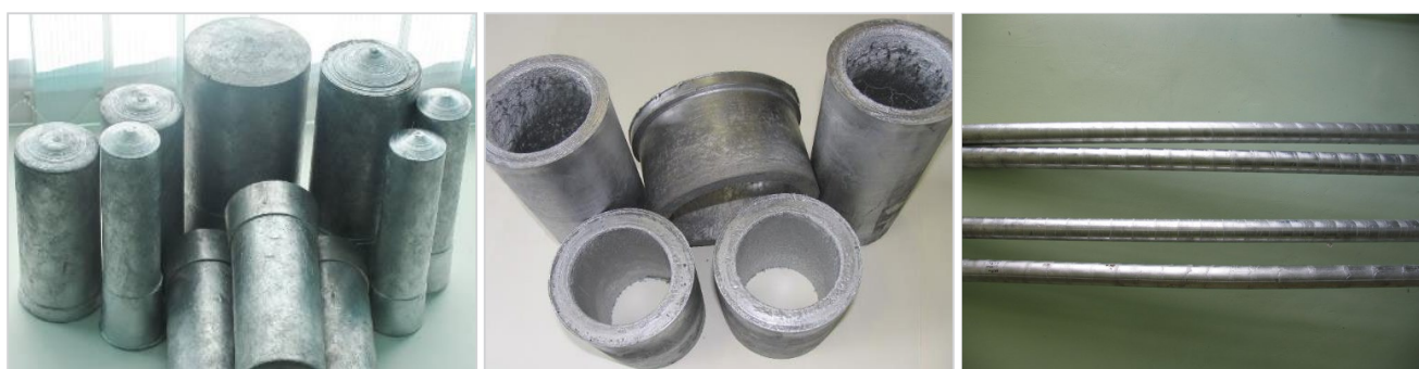
Рис. 3. Литые заготовки из силуминов с высокодисперсной инвертированной микроструктурой
