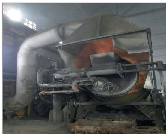
Рис.8. Выбросы газов из РНП при неплотном прилегании крышки
