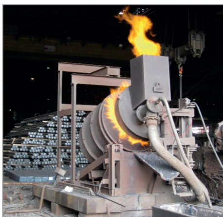
Рис.8. Выбросы газов из РНП при неплотном прилегании крышки
