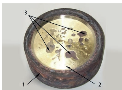
Рис. 3. Биметаллическая заготовка после удаления части наплавленного слоя: 1 – стальное основание; 2 – бронзовый слой; 3 – раковины
