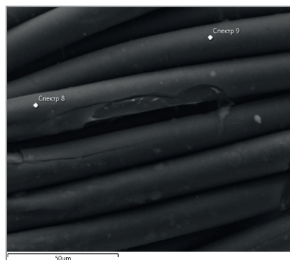
Рис. 6. Дефекты поверхности ткани 05C8-КВ с покрытием алюминий – углерод; растровая микроскопия
