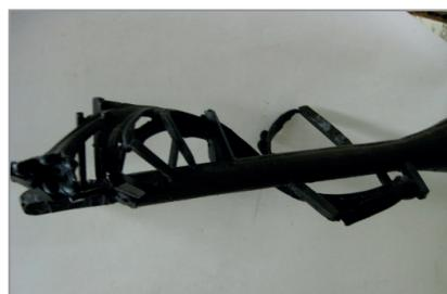
Рис. 6. Расположение стояка по воображаемой оси вращения отливки
