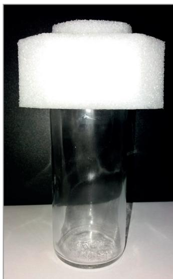
Рис. 1. Общий вид модели с теплоизолированной верхней частью
