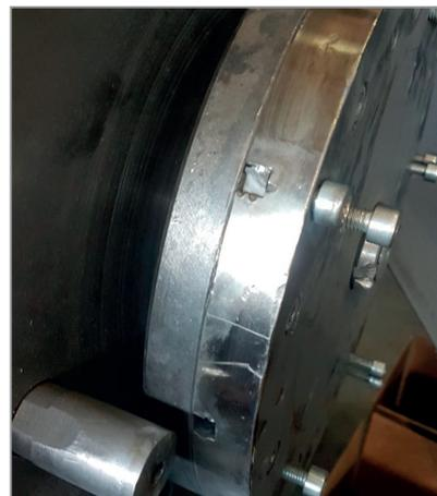
Рис. 3. Разрушение ножа в посадочном гнезде
