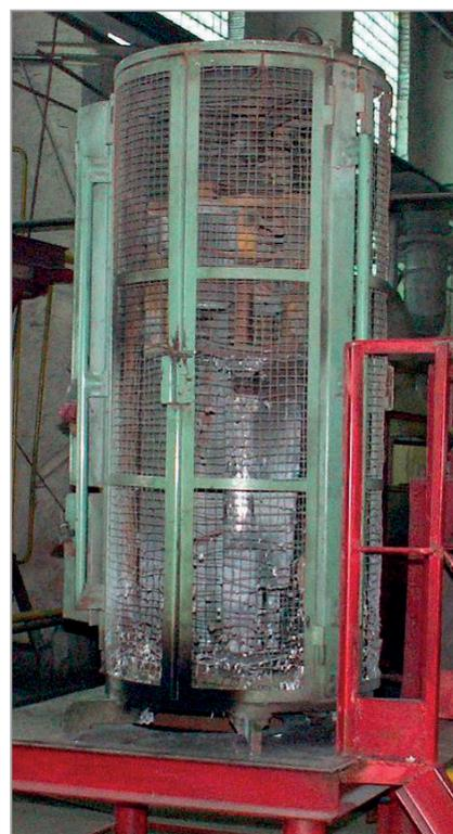
Рис. 3. Установка для рафинирования алюминиевых сплавов мод. 46161
