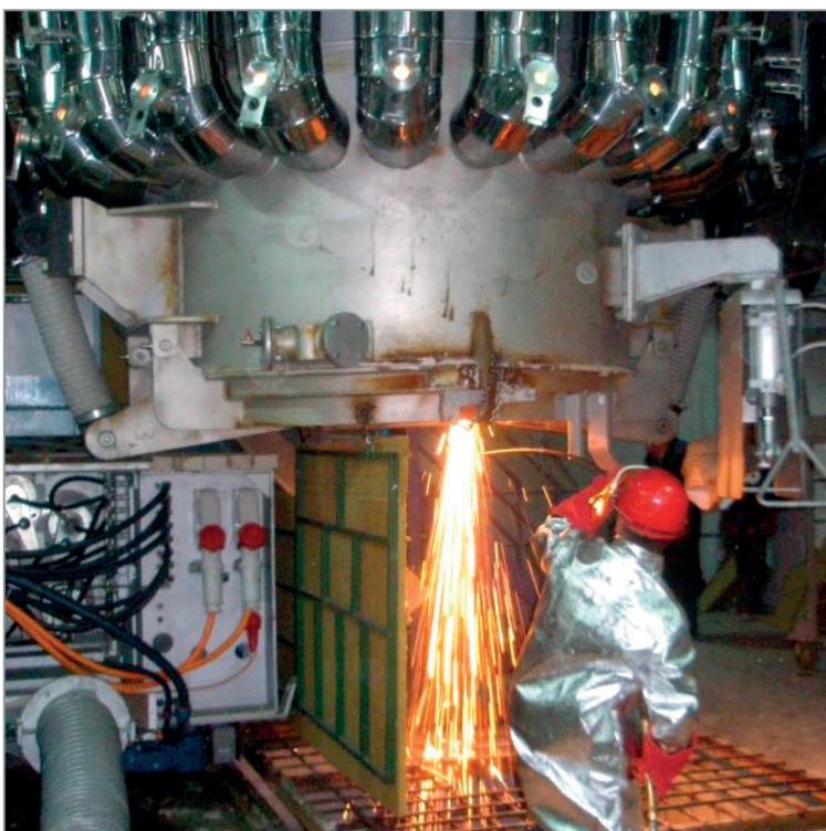
Рис. 2. Прожигание донного отверстия кислородом для слива металла
