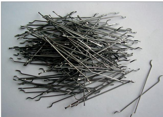
Рис. 2. Фибра стальная анкерного профиля
