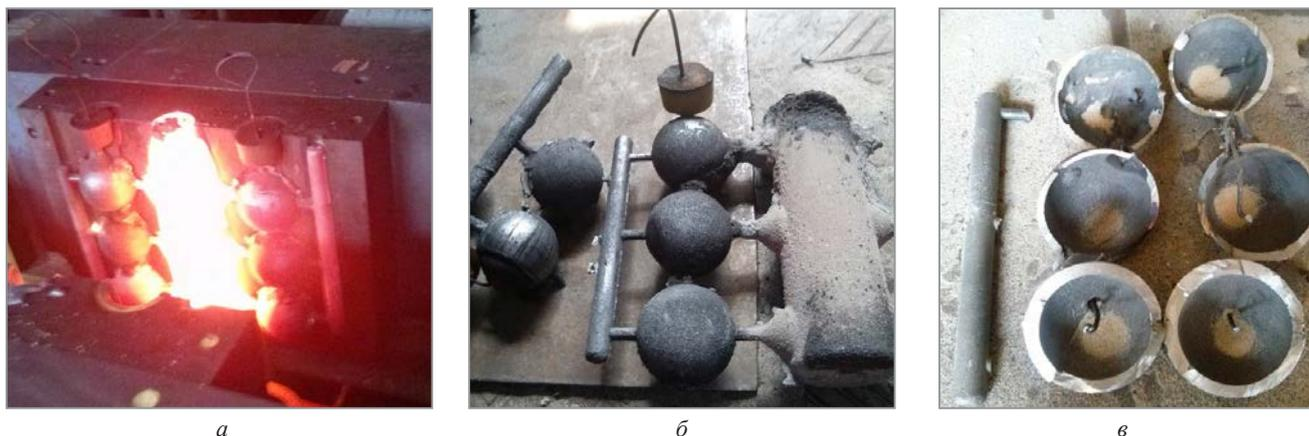
Рис. 3. Куст стержневых отливок в облицованном кокиле (заливка через центральный стояк) (а); стержневые пробы-отливки с литниковой системой (б); разрезанные шаровые отливки, полученные литьем через центральный стояк с толщиной стенок 10 мм, 6 и 4 мм (в)
