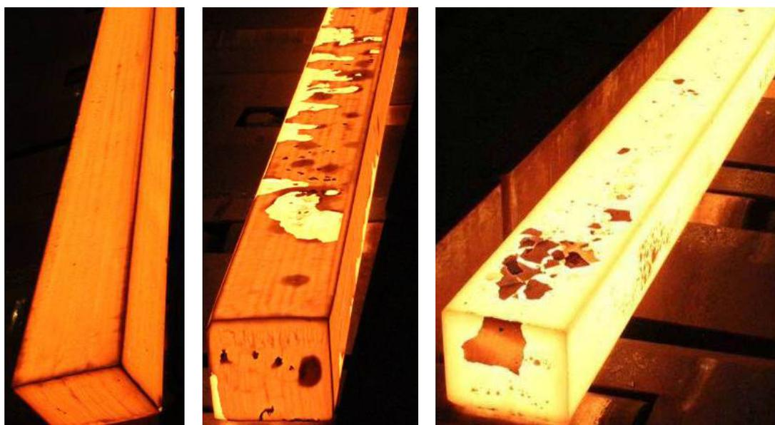
Рис. 4. Внешний вид непрерывнолитой заготовки после нагрева перед деформацией:
