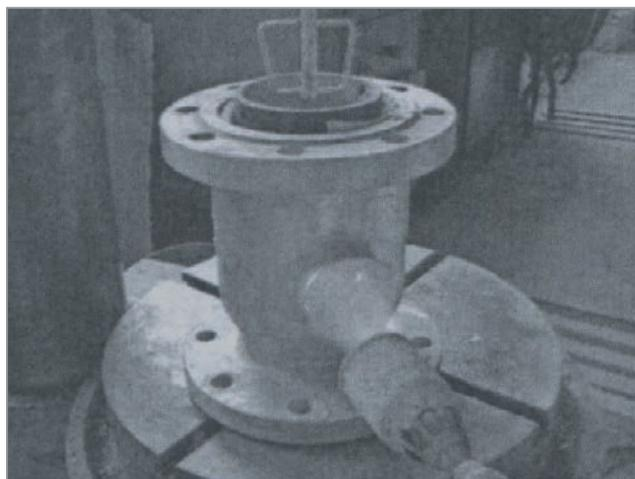
Рис. 1. Оборудование для ввода модификаторов и механического перемешивания расплава
