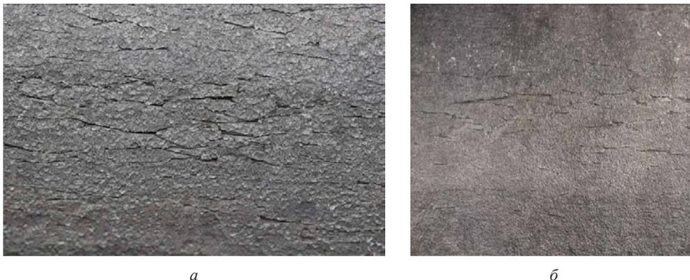
Рис. 7. Поверхность горячекатаного проката после удаления поверхностной окалины:
