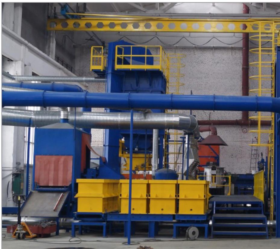
Рис. 1. Механизированная линия ЛГМ
