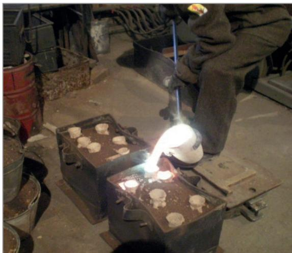
Рис. 8. Заливка форм
