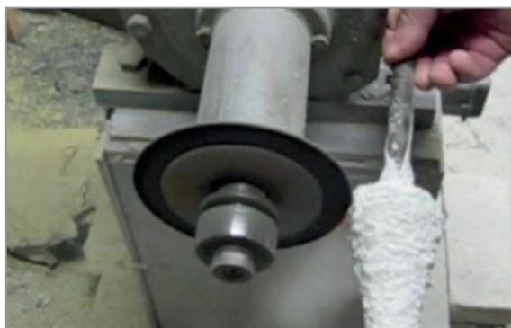
Рис. 5. Прорезка формы перед удалением модельного состава
