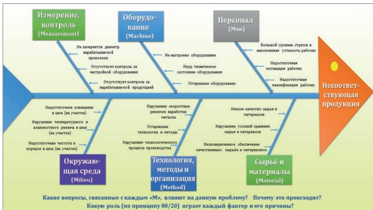
Рис. 1. Пример модели Исикавы или метод 6М
