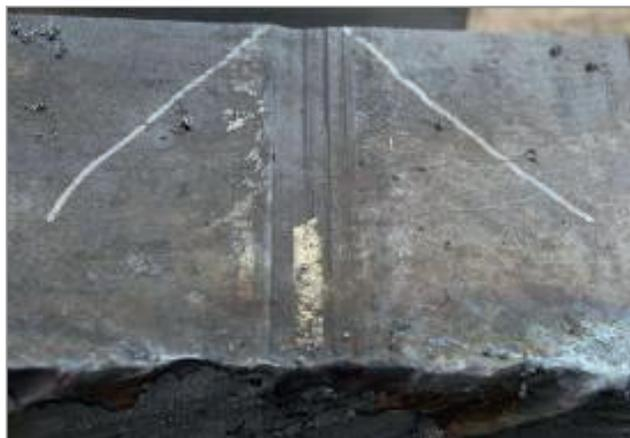
Рис. 3. Внешний вид дефектов на непрерывнолитой заготовке плавки № 3
