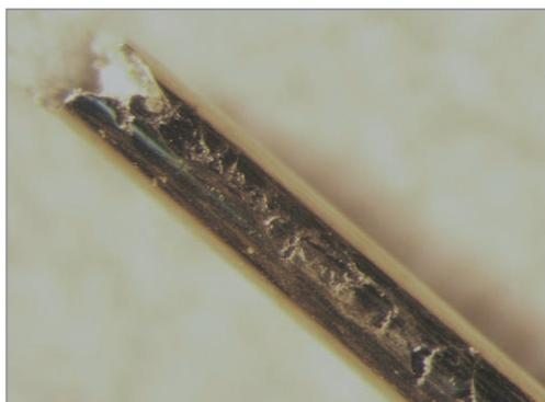
Рис. 1. Внешний вид хрупкого разрушения по поверхностным трещинам. х25
