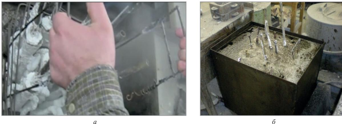
Рис. 7. Операция удаления модельного состава из формы:
