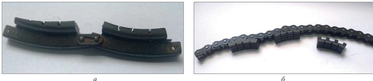
Рис. 2. Сравнение конструкций серийных и модернизированных тормозных цепочек:
