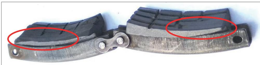
Рис. 1. Состояние износа тормозных колодок (серийные цепочки)
