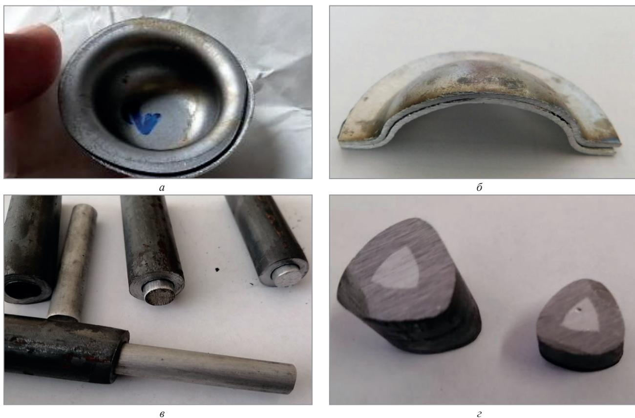
Рис. 1. Внешний вид (*а, в*) и поперечный разрез (*б, г*) экспериментальных образцов слоистых композитов, полученных с использованием различных схем деформации материалов на основе железа и алюминия:
